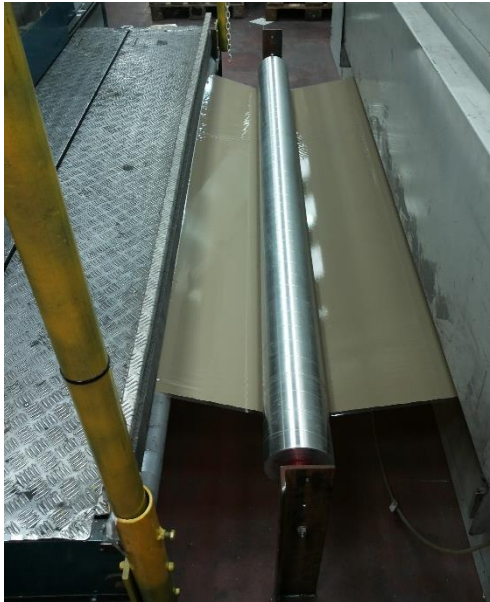
Figura 6.11: Nuovo cilindro di accarezzamento esterno alla macchina
