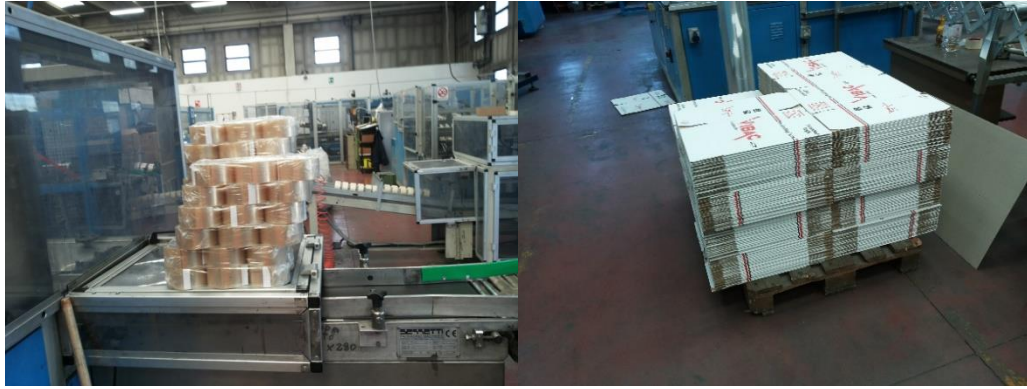
Figura 6.3: Panetti eliminati dal flusso in seguito alla rottura della scatola
