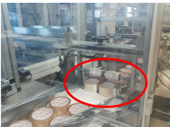
Figura 7.6: Chele che consentono l'avanzamento rotoli
