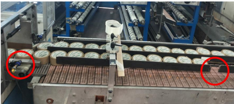
Figura 7.8: Indicazione sul piazzamento del nuovo sensore
