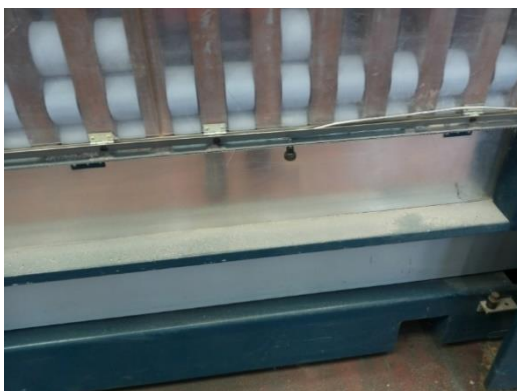
Figura 3.6: Polvere all'esterno della macchina
