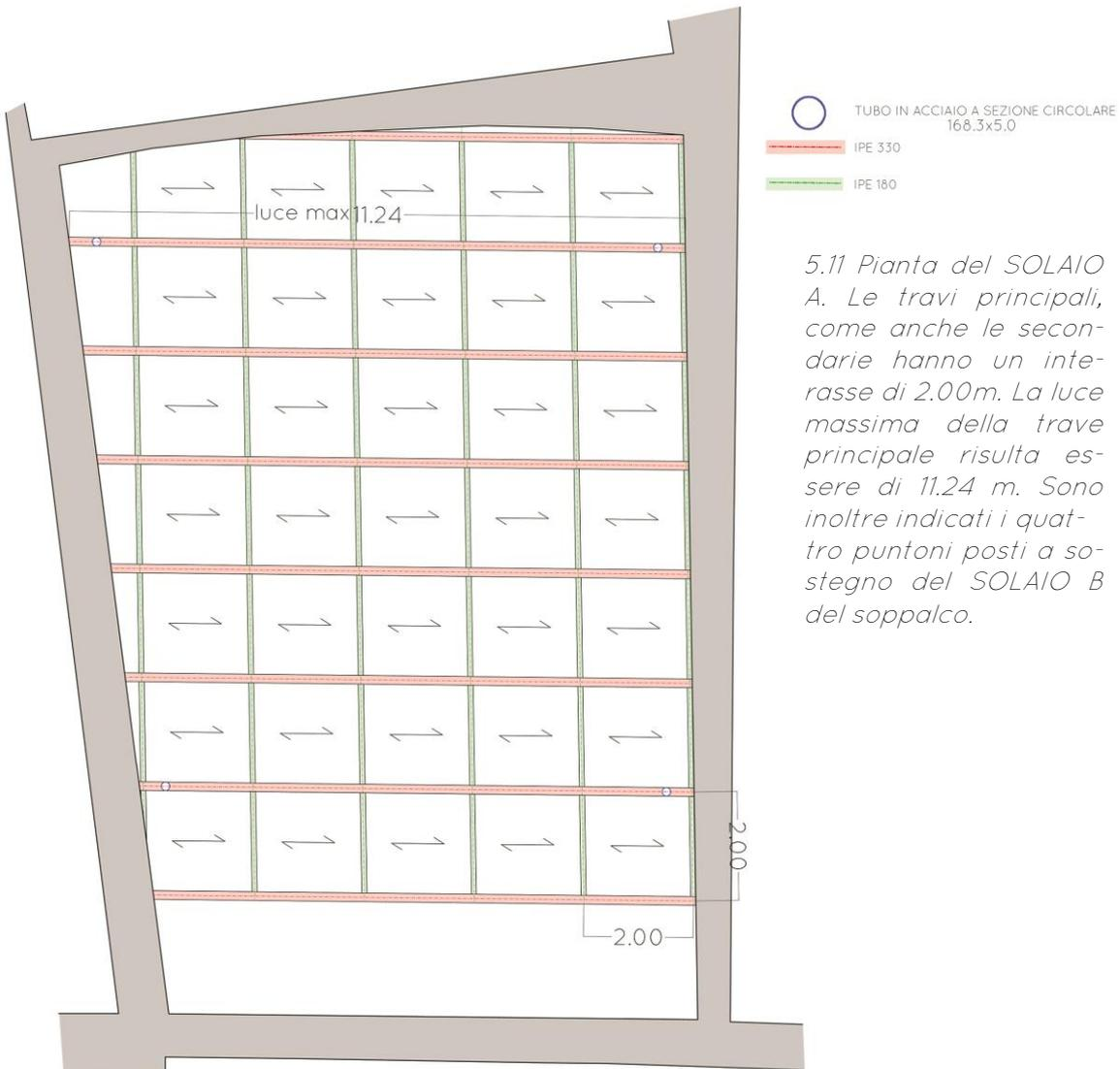
5.11 Pianta del SOLAIO A. Le travi principali, come anche le secondarie hanno un interasse di 2.00m. La luce massima della trave principale risulta essere di 11.24 m. Sono inoltre indicati i quattro puntoni posti a sostegno del SOLAIO B del soppalco.
