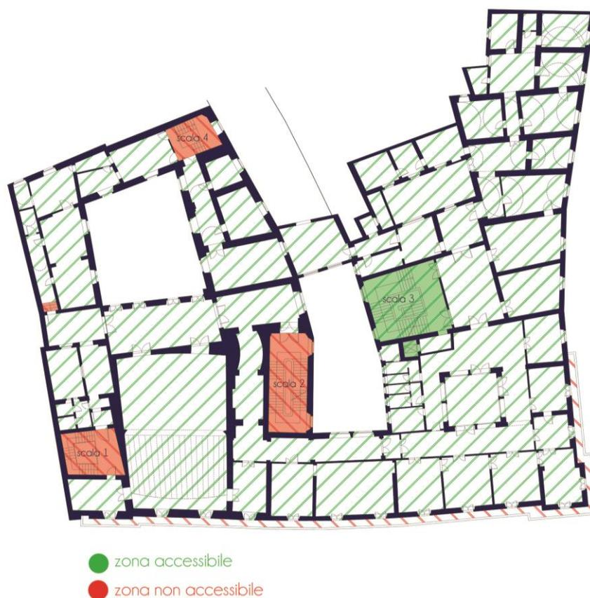
Il primo livello è accessibile attraverso l'ascensore situato accanto alla scala 3. Data l'assenza di altri elevatori o servoscala la fruibilità di gran parte dell'edificio rimane comunque scomoda ai diversamente abili. Con l'introduzione di un nuovo ascensore nel vano della scala 1 e il servoscala alla scala 2, sarà migliorata notevolmente la fruibilità dell'edificio.
