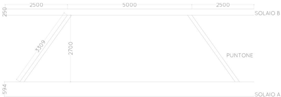
5.12 Schema puntone trave a sostegno del SOLAIO B.
