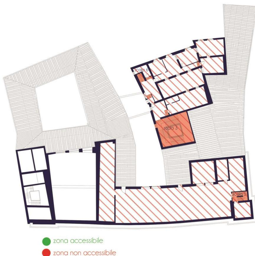
L'ultimo livello dell'edificio è completamente inaccessibile ai diversamente abili. Non è possibile dotare la scala 5 di montascale. L'accesso a questa zona sarà garantito con il prolungamento della scala 1 e del suo ascensore.
