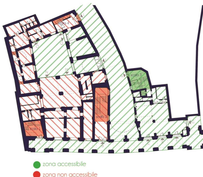
Come possiamo vedere da questa schematizzazione molti degli ambienti nell'ala sud ovest non sono accessibili a tutti. Inoltre l'unica scala che permette di arrivare ai piani superiori è la scala 3, dotata di un servoscala che permette di raggiungere la quota dell'ascensore. Gli ingressi A, B, I, L, M, N e P vanno dotati di rampe per l'accesso alla struttura. Al centro della scala A verrà posto un nuovo ascensore, mentre alla scala 2 dovrà essere installato un servoscala.
