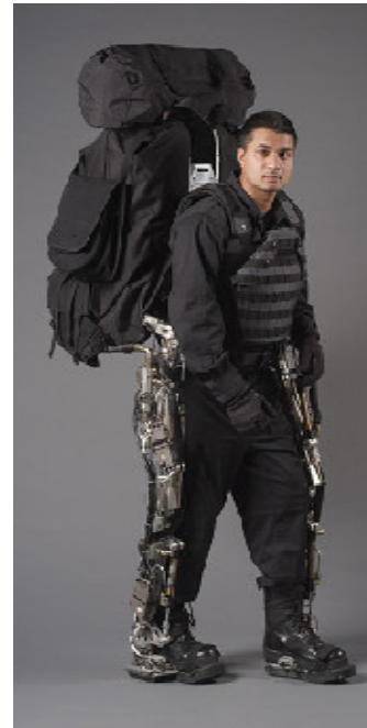
Figura 6 - Il sistema BLEEX
