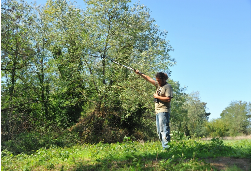
Figura 5: Uso dell'antenna Yagi costituita da tre elementi flessibili e la ricevente spalleggiabile, durante l'attività di radiotracking
