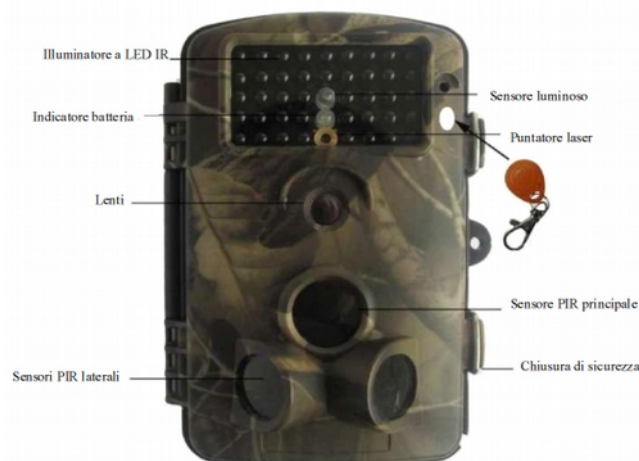
Figura 37: Modello Multipir-12 con funzione audio, in questa foto sono indicate alcune componenti
