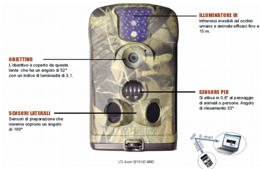
Figura 38: Modello LTL Acorn 6210 HD SMS, il modello in foto ha l'opzione di invio E-mail o SMS/MMS in caso di video ricevuti. È necessario, in questo caso, inserire una SIM card.
