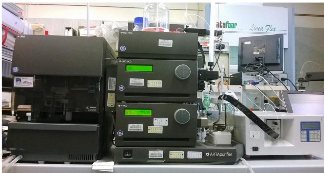
**Figura 1.11** Sistema FPLC dotato di una colonna cromatografica per esclusione molecolare ed un rilevatore spettro fluorimetrico.
