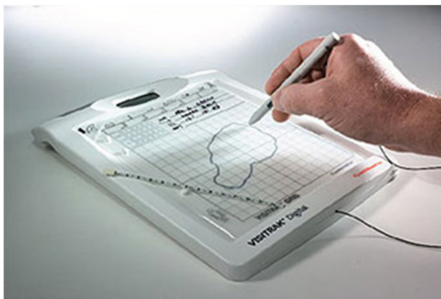
Fig.17: Esempio di planimetria digitale , il Tablet Visitrak .
