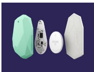
Figura 8. Costituzione del dispositivo Beacon dell'azienda ESTIMOTE, fonte ESTIMOTE
