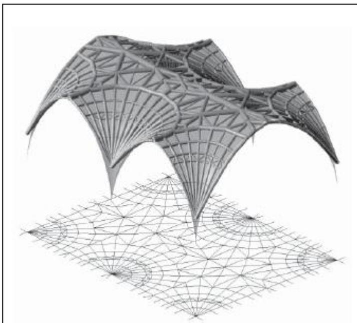
Figura II-6 – Superficie target e soluzione best-fit per la volta dell'Abbazia di Sherborne, individuata da Block e Lachauer [Errore. L'origine riferimento non è stata trovata.].
