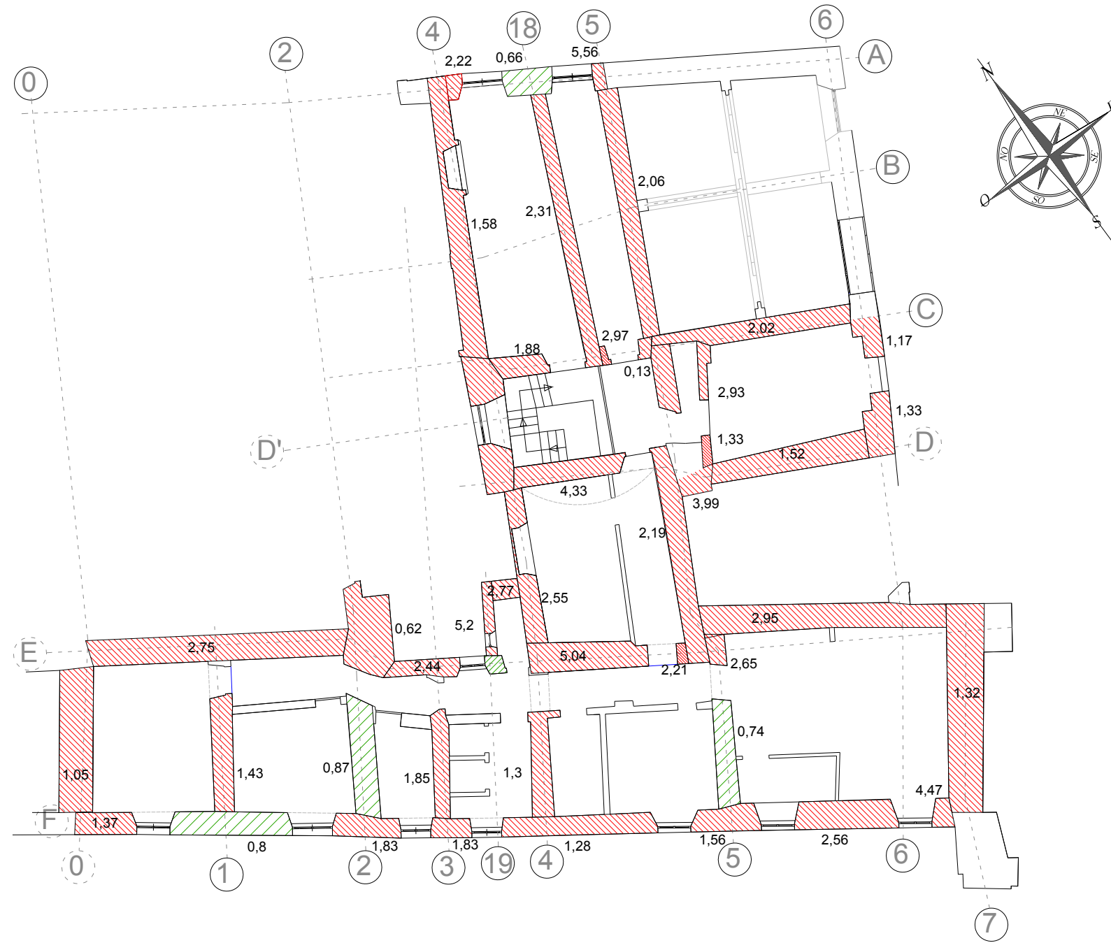
Figura 4.1-36: Verifiche di taglio congiunte per carichi sismici in direzione X (SLV) Piano Ammezzato
