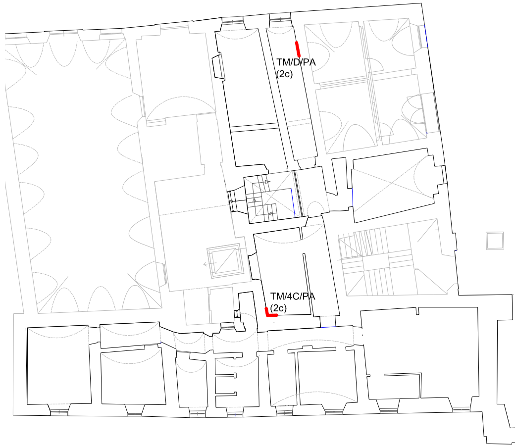
Figura 2.4-7: Saggi murature piano ammezzato (2 saggi)
