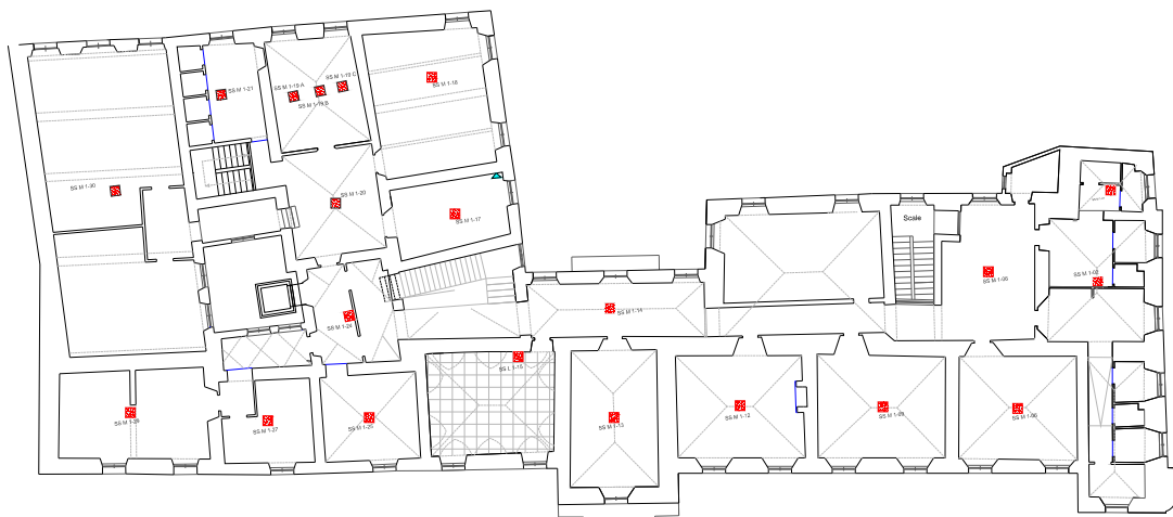
Figura 2.4-30: Saggi solaio piano primo, 21 saggi
