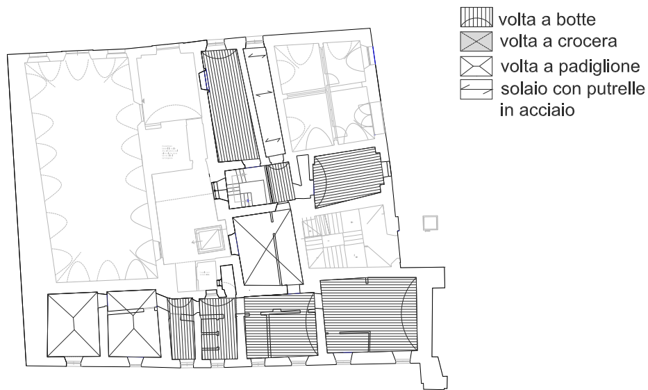
Figura 2.4-24: Schema strutture portanti piano ammezzato
