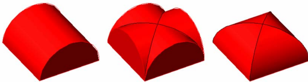
Figura 2.4-21: Principali tipologie di volte, botte, crociera, padiglione
