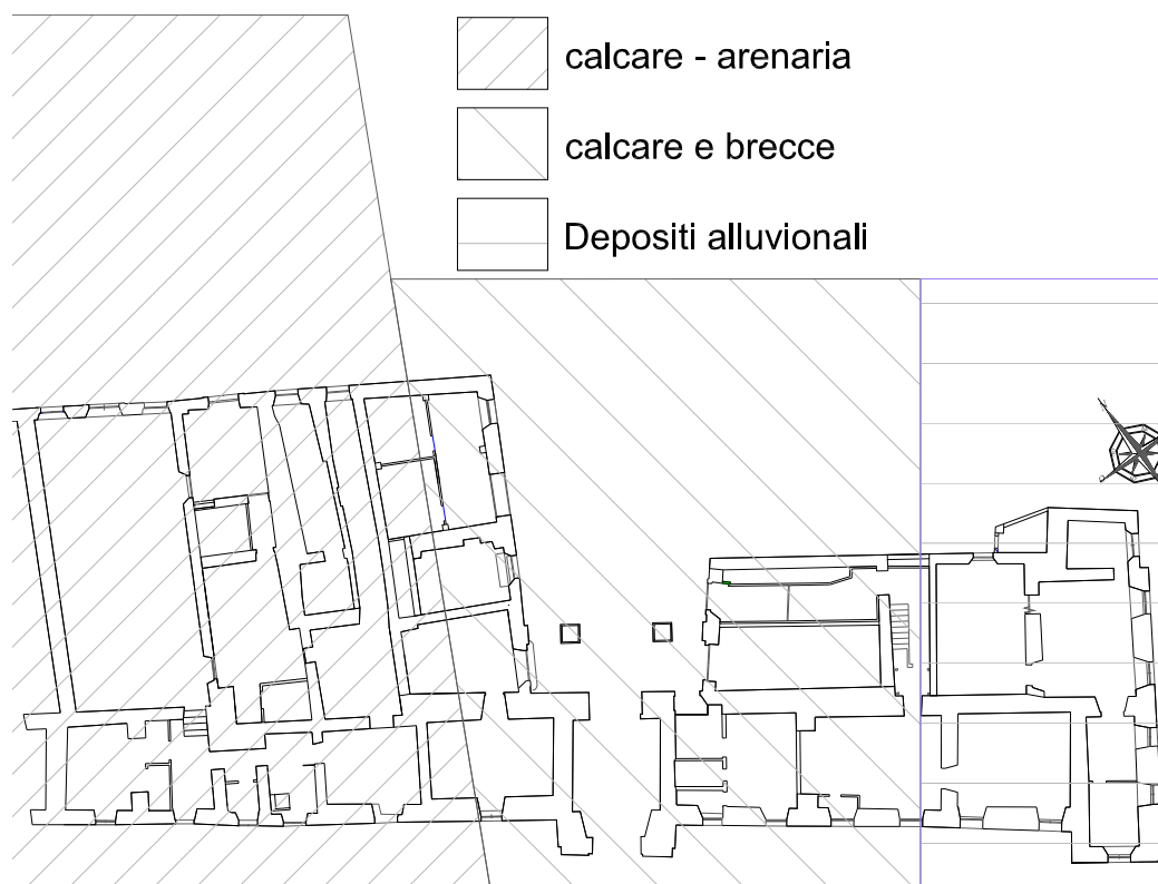
Figura 3.3-1: Disposizione dei 3 tipi di terreno riscontrati
