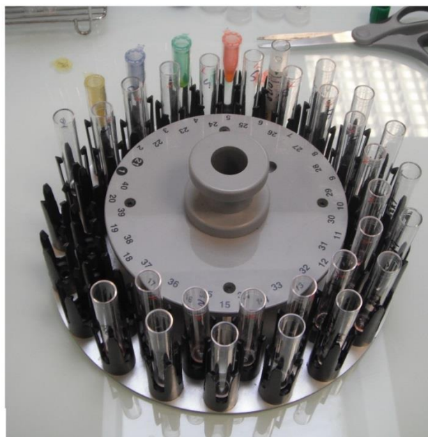
Figura 17- Piatto mobile di reazione di Rx daytona® (foto del laboratorio Oniris di Nantes)
