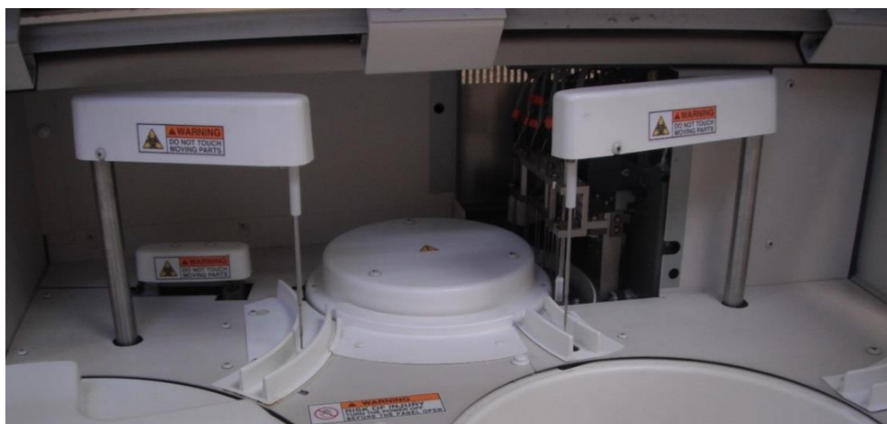
Figura 18- Micropipette automatiche miscelanti di Rx daytona® (foto del laboratorio Oniris di Nantes).
