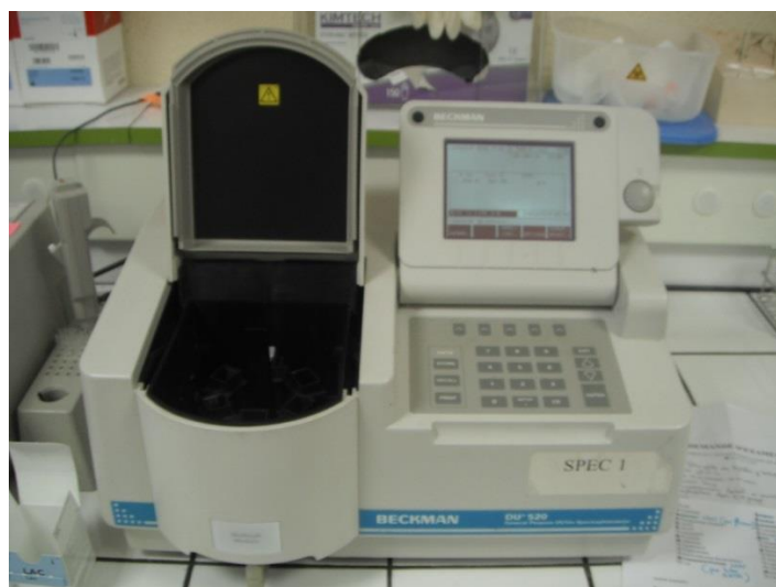
Figura 16- Rappresentazione dello strumento Beckman DU 520 ® (foto del laboratorio Oniris di Nantes). In questo laboratorio, è stato utilizzato per la misurazione della quantità di emoglobina presente in campioni emolitici.
