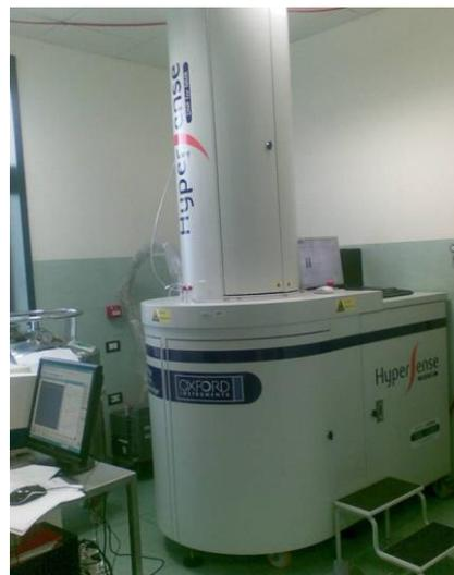
Figura 1.6: Iperpolarizzatore DNP (Hypersense<sup>®</sup>), installato presso il laboratorio di risonanza magnetica della Fondazione CNR/Regione Toscana G.Monasterio, Pisa.
