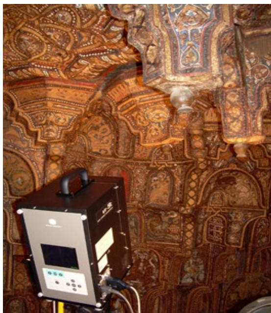
Figura 12 – Scanner laser a triangolazione
