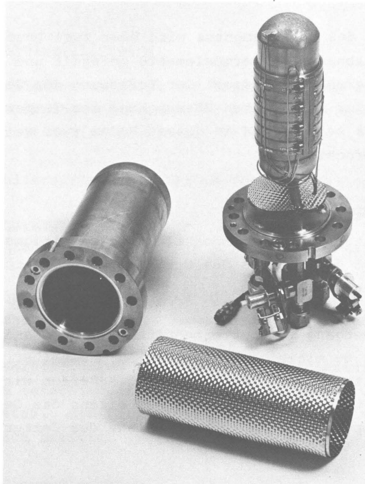
Abb. 3.5: Getterbehälter, Außenbehälter und Strahlungsschild des Tritium-Lagerbehälters
