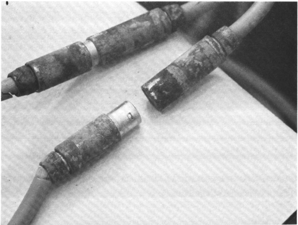
Abb. 19: Korrosionserscheinungen an den verchromten Steckverbindungen
