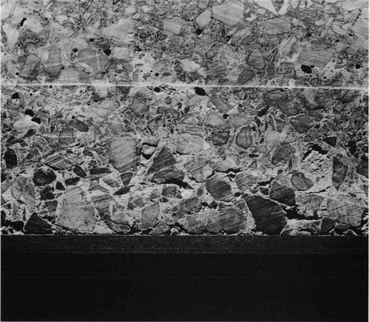
Abb. 36: Gestörter Liner-Beton-Kontakt
