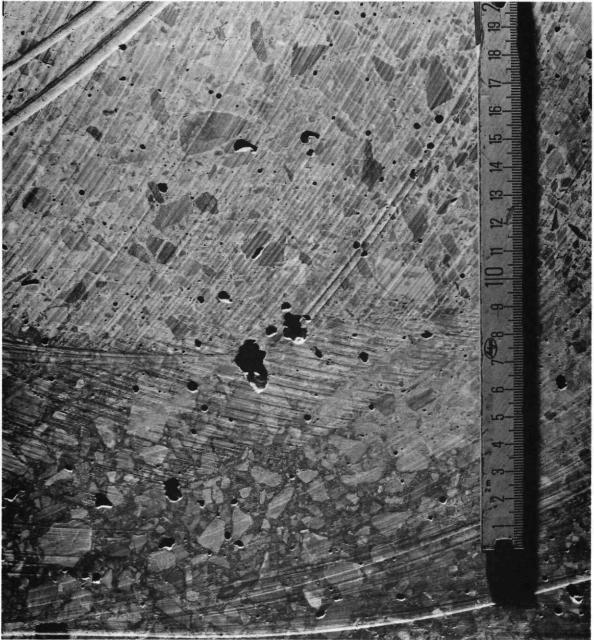
Abb. 34: Typische Poren- und Lunkerverteilung im Beton
