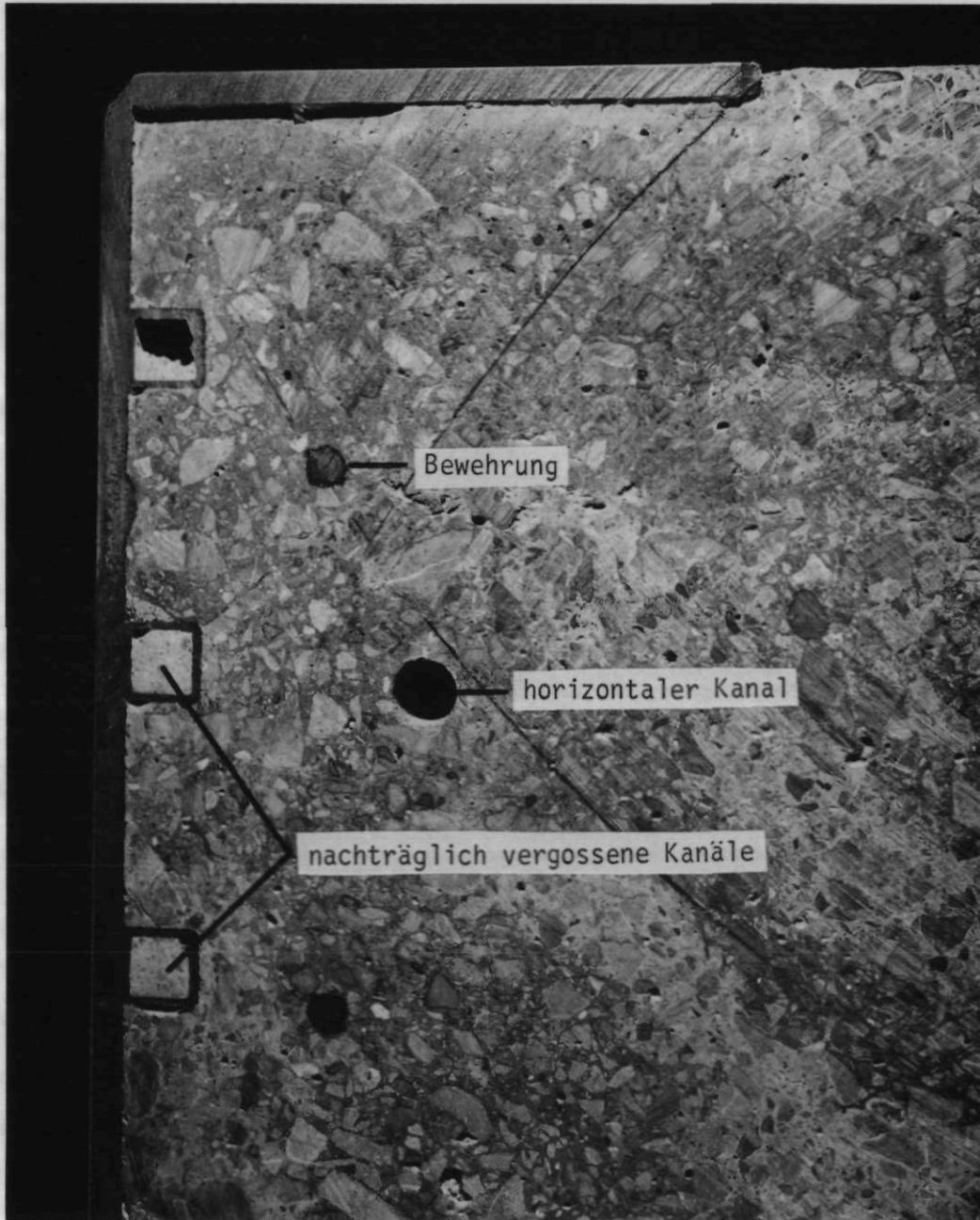
Abb. 38: Teilansicht einer Schnittfläche durch das Versuchsmodell
