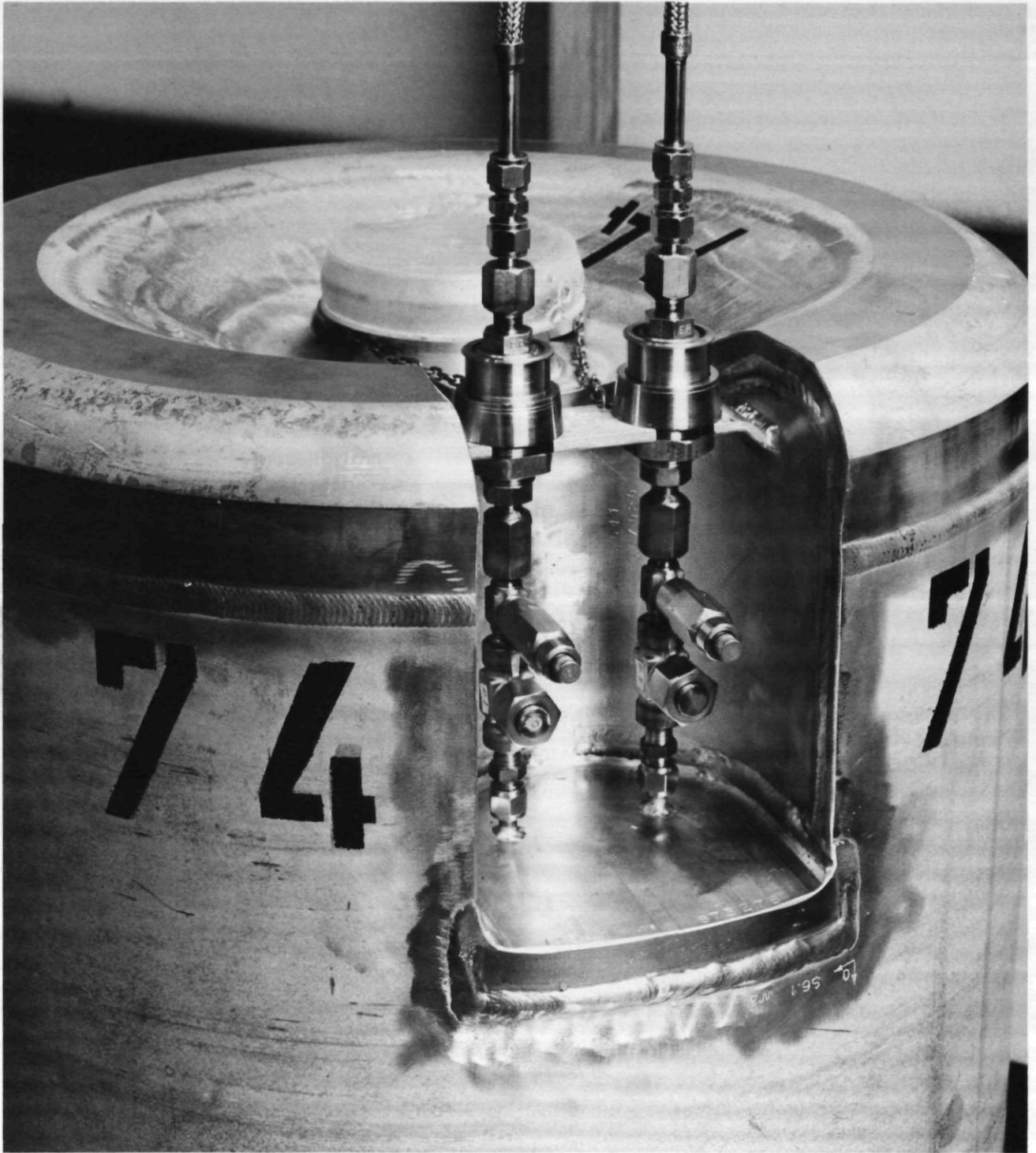
Abb. 18: AVR-TL-Ventilkanne mit aufgesteckten Gasleitungen
