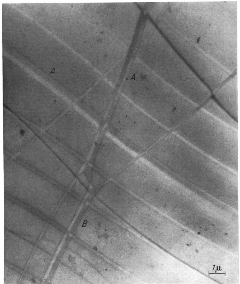
Fig. 7. Dreifache Bänder in Stapelfehlerkontrast. *A* Dreifache Bänder mit zwei gleichartigen Stapelfehlern. *B* Dreifaches Band mit zwei verschiedenen Stapelfehlern
