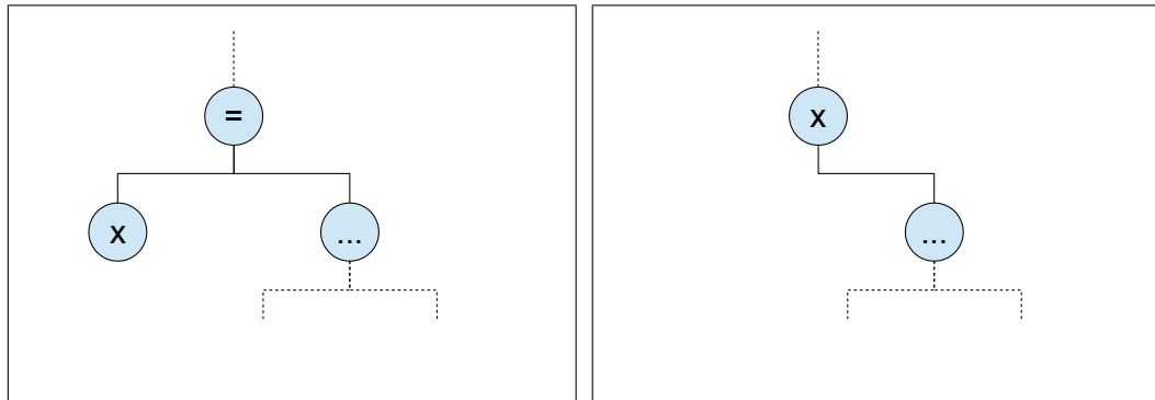
Abbildung 3.10: Entfernung von Zuweisungsknoten durch Umstrukturierung des abstrakten Syntaxbaumes
