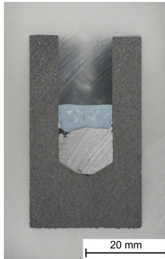
Abbildung 24: Querschnitt durch einen erkalteten Graphittiegel mit einer ausgeprägten Kontaktfläche von Roheisen und Schlacke, die sich bei 1600 °C bildet
