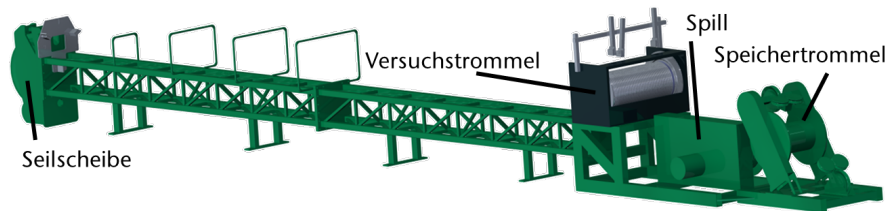
Abbildung 1: Wickelprüfstand am IMW zur Analyse des Zusammenspiels von Seil und Seiltrommel
