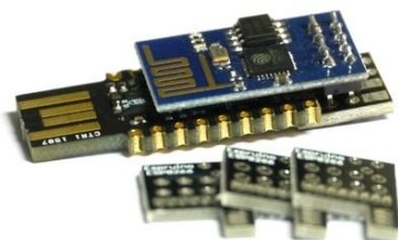
Abbildung 5-2: Espruino Pico mit aufgelötetem ESP8266 (ESP-01) [96]
