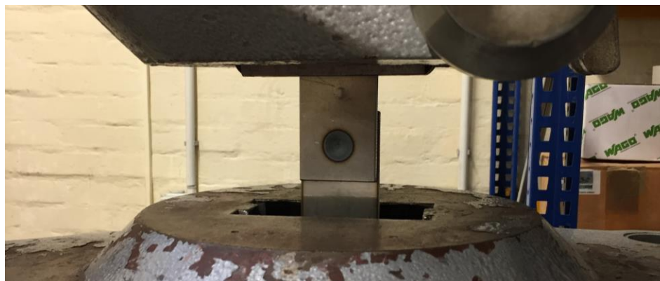
Slika 45. Uzorak stegnut u čeljusti kidalice
