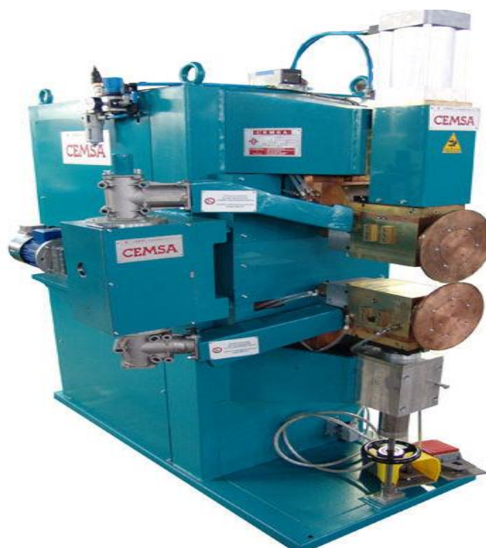
Slika 8. Uređaj za šavno zavarivanje [9]
