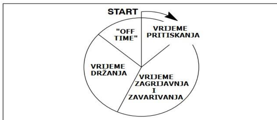
Slika 16. Vremenski ciklusi pri elektrootpornom zavarivanju [12]
