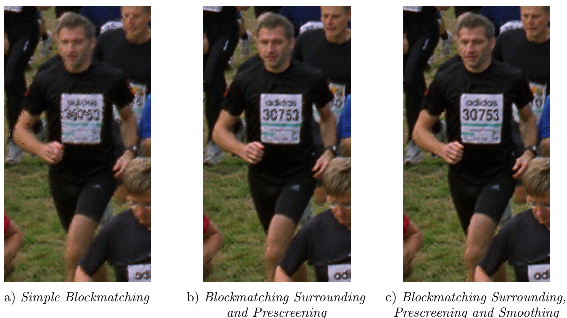
Abbildung 11.6 Auswirkung der Blockmatching Verfahren
