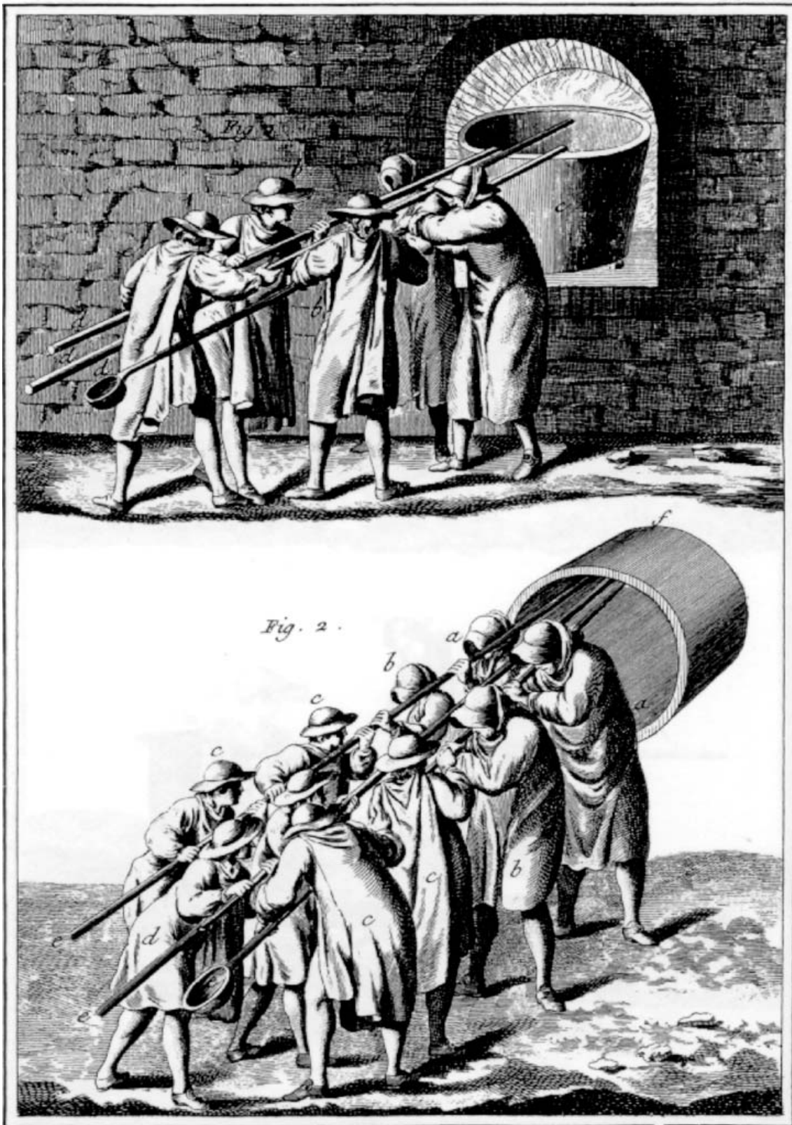
Verrerie en bois, l'opération de tirer le Pot hors de l'Arche, et l'opération de le porter au Four.
