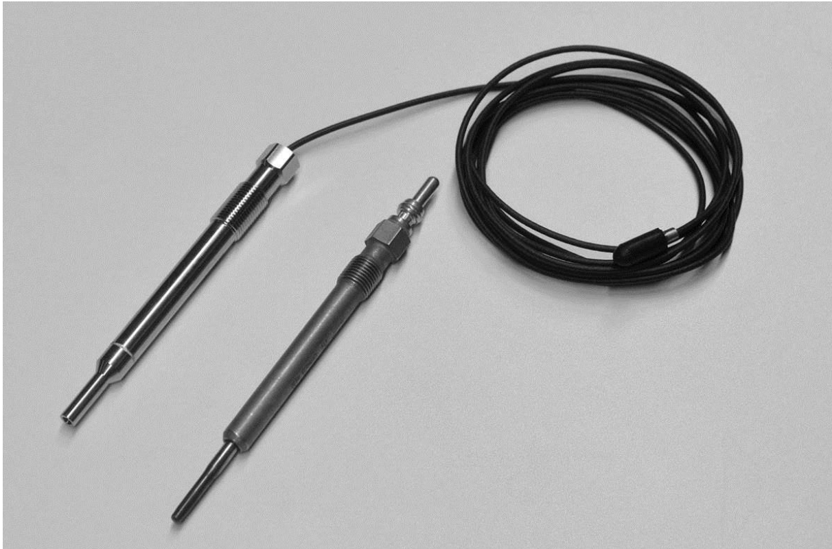
Abbildung 3-18: Glühkerzenadapter mit Druckmessquarz und Serienglühkerze. Der kompakte Druckmessquarz ist mit dem Glühkerzenadapter verschraubt.
