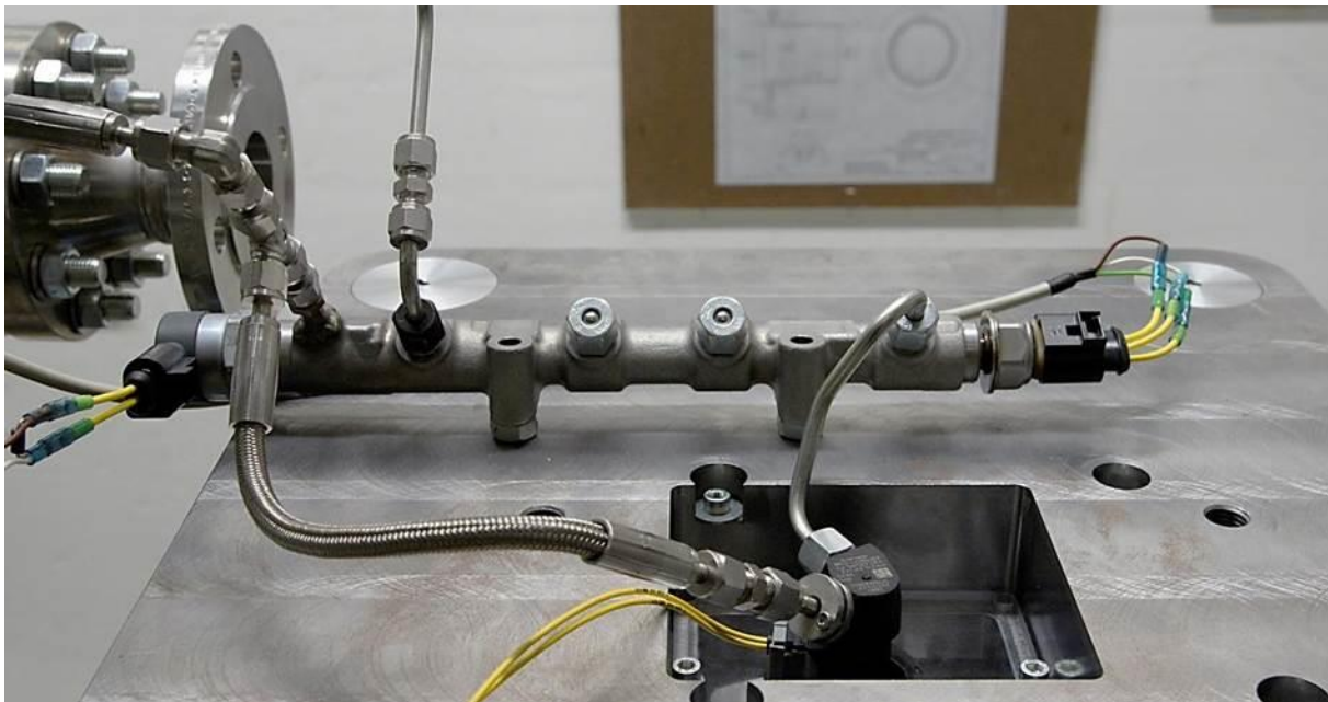
Abbildung 3-11: Modifizierter Hochdruckspeicher mit angeschlossenem Injektor [74]. Die hier nicht verwendeten zwei Abgänge der im Serienzustand vorhandenen Injektoren sind mit Wälzlagerkugeln verschlossen.
