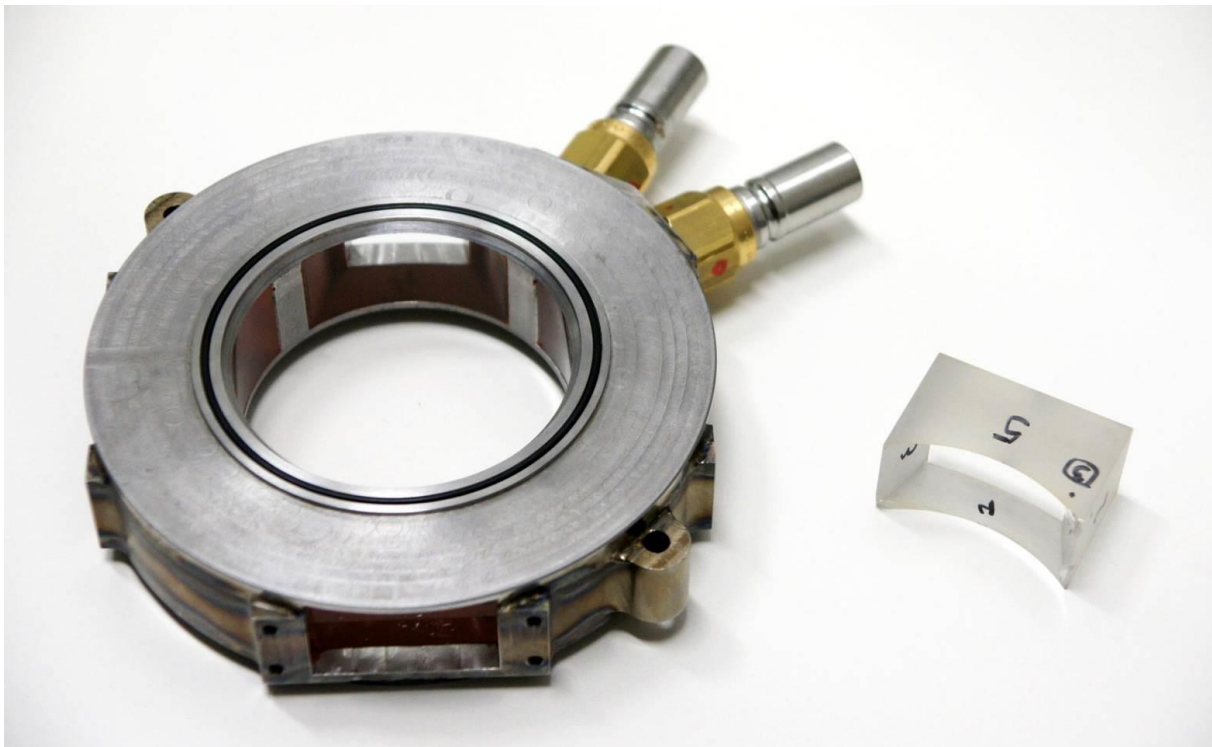
Abbildung 2-30: Transparenter Zwischenring und Quarzglasfenster. Vier dieser Fenster sind über dem Umfang des Zwischenringes eingeklebt.
