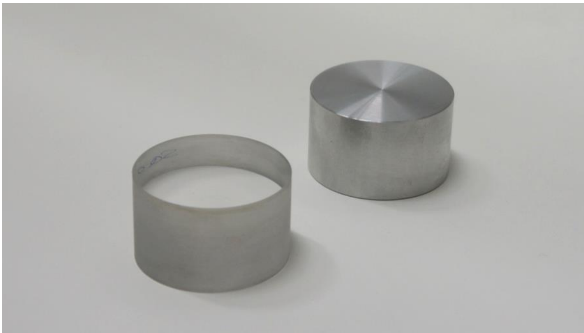
Abbildung 2-45: Kolbenglas für die Rechteckmulde und optionaler Aluminiumeinsatz für Testanwendungen.
