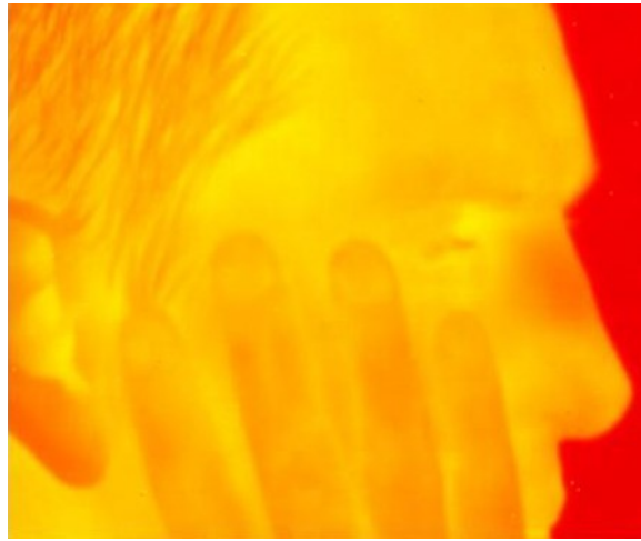
Abbildung 3.4: Thermographie-Aufnahmen ohne zusätzliche Bildbearbeitung. Als Detektor wurde ein 17- \mu\text{m} -Pixel-Pitch-IRFPA mit QVGA-Auflösung verwendet [7].
