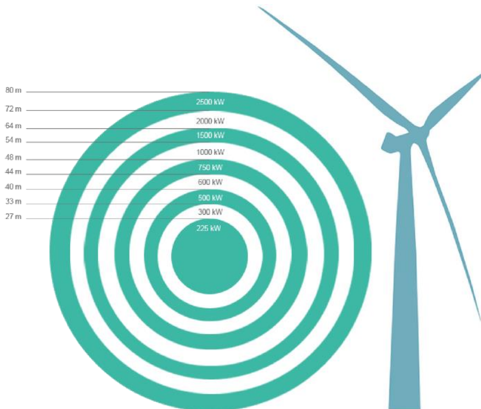
Figure 4 : Puissance en fonction du rayon du rotor pour éolienne à 3 pâles ( www.iscience.ca )
