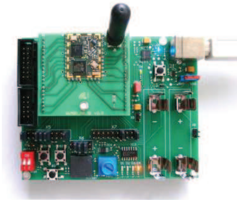
Figure 9 - IM880A et la carte de démonstration
