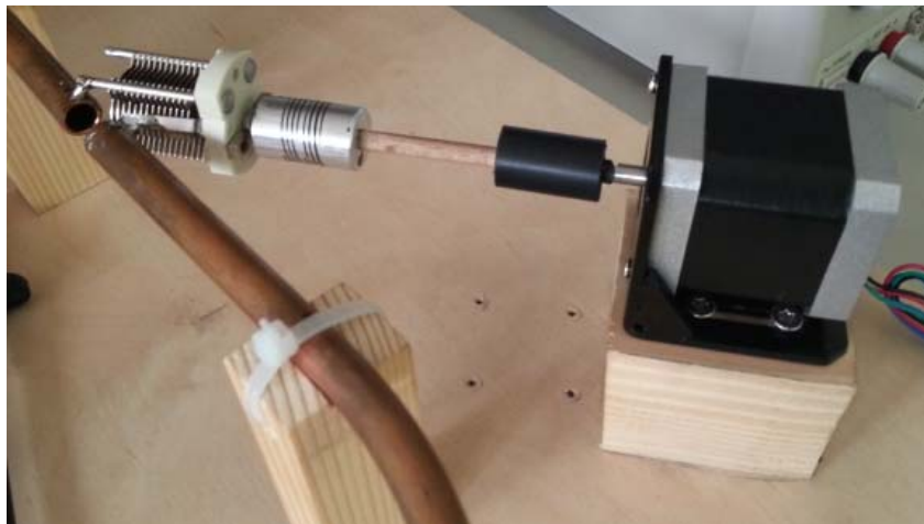
Figure 11 : Accouplement du condensateur et du moteur
