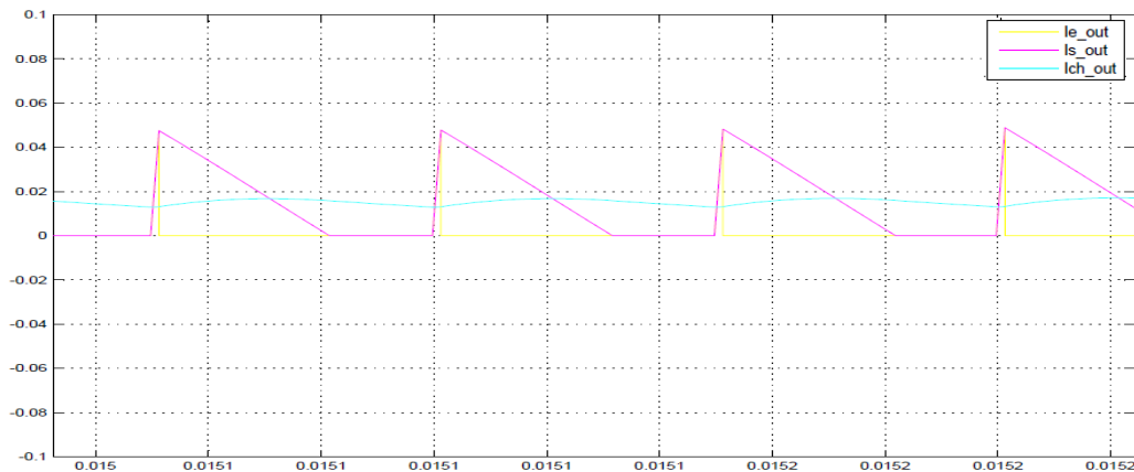
Figure 60: Courant du convertisseur quand la PWM est minimale
