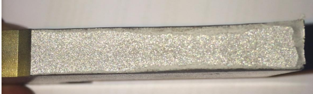
Figure 24 : Lèvres aux bords de la surface de rupture
