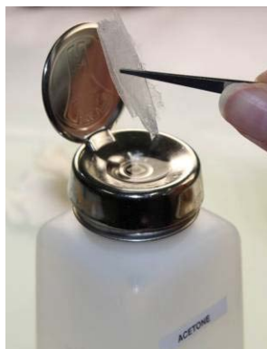
Photo 67 : Mouillage et essorage du papier Japon imprégné d'acétone. (©Cataldi M.)
