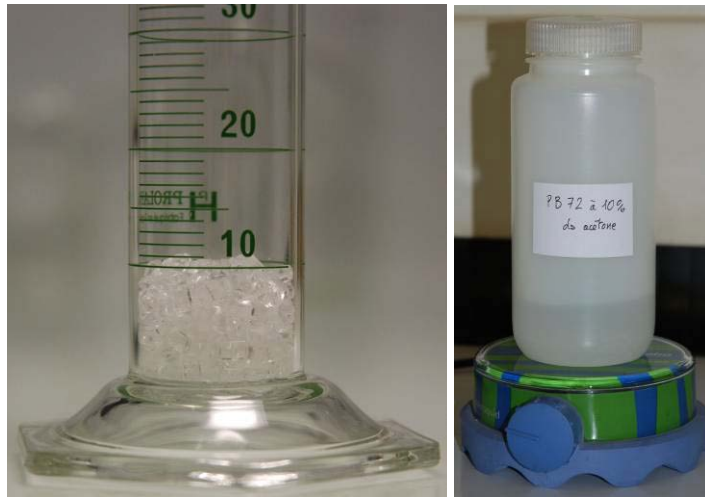
Photo 33 : 10ml de Paraloid B72 dans éprouvette graduée de 100ml. (©Paillier A.)
