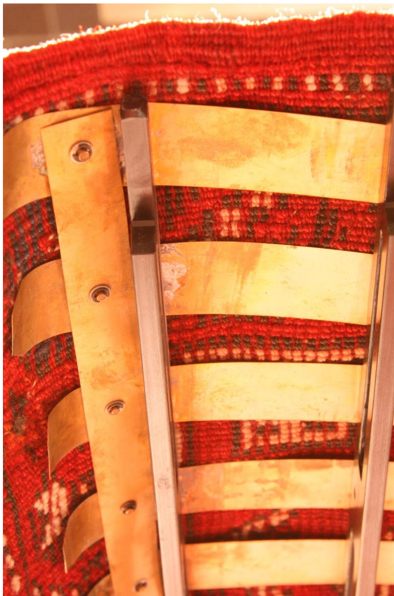
Figure 57 : Système de fixation des lames de cupro-bérylium.
