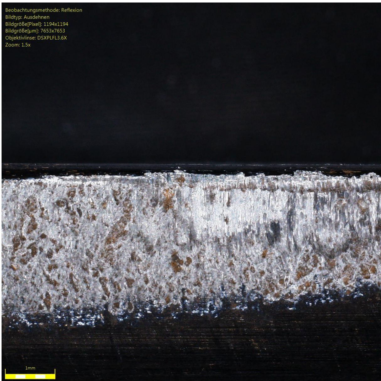
Figure 27 : Vue EFI du détail de l'usure du bras en aluminium.
