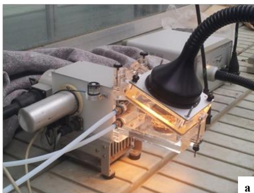
Abbildung 6. a) Küvette mit Beleuchtung für Photosynthese, b) abgedunkelte Küvette für Respiration
