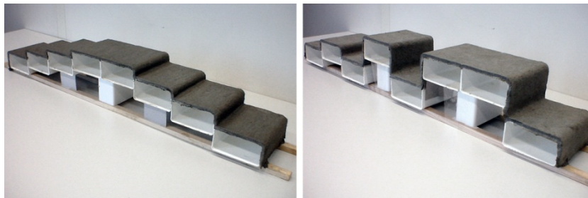
Abbildung 27a und b: Kundenspezifisches Regalelement aus Eternit im Trocknungszustand auf einem auswechselbaren Produktionstisch mit unterschiedlicher Parametereinstellung
