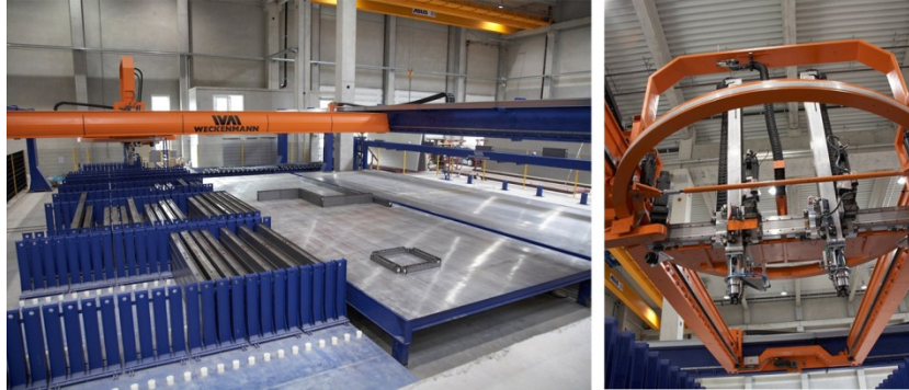
Abbildung 6a und b: Betonschalungsroboter Twin-Z mit Werkzeugwechsler der Firma Weckenmann
