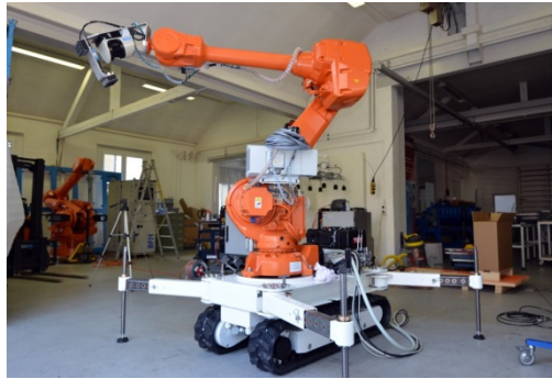
Abbildung 69a und b: a) die komplette Anlage in einem ausgefahrenen Zustand; b) der Baubereich der mobilen Fabrikationseinheit in der Draufsicht
