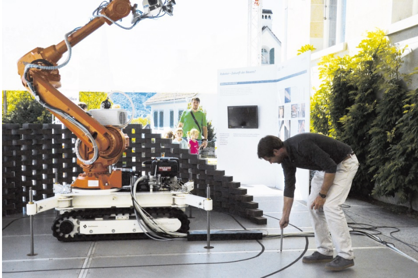
Abbildung 82: Über die am Roboter installierte 3-D-Kamera konnten menschliche Bewegungen aufgenommen und gespeichert werden
