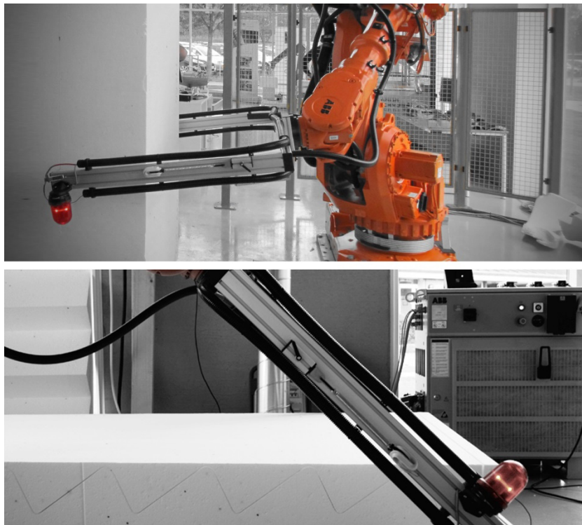
Abbildung 9a und b: Der von der Firma Odico entwickelte Heißdrahtschneideprozess für die roboterbasierte Fertigung von EPS-Schalungselementen
