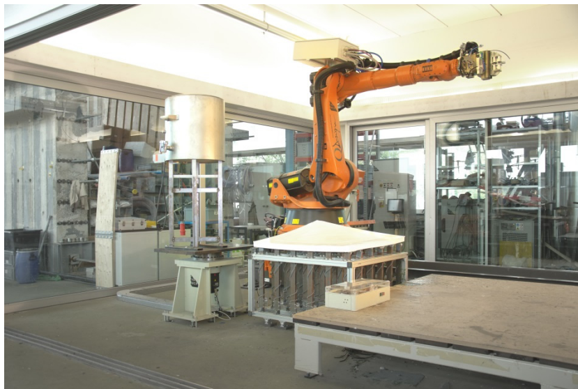
Abbildung 7: Ein vom Roboter aktivierter Schalungstisch
