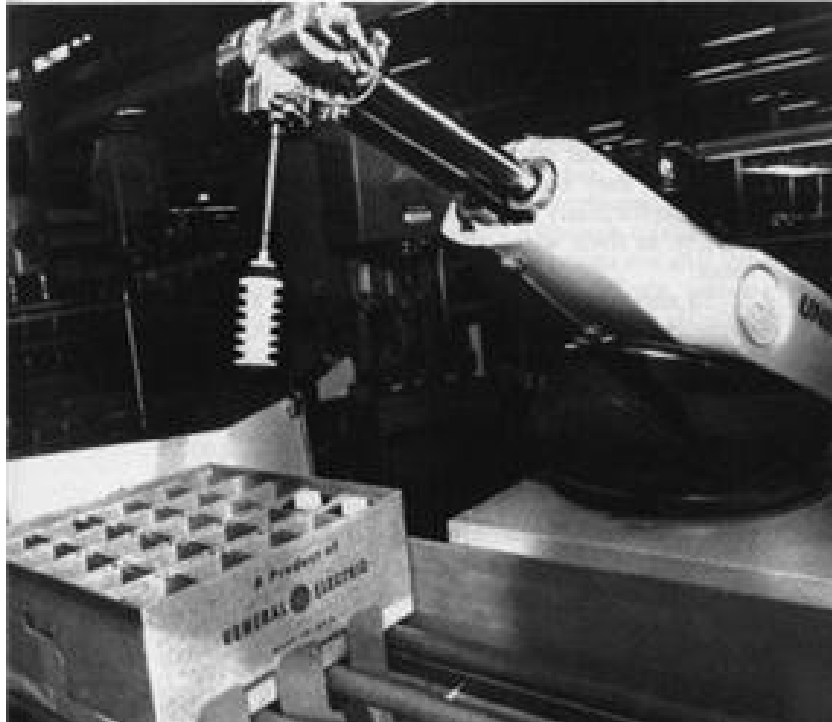
Abbildung 20: Erster Industrieroboter Unimate, 1961, im Einsatz bei General Motors
