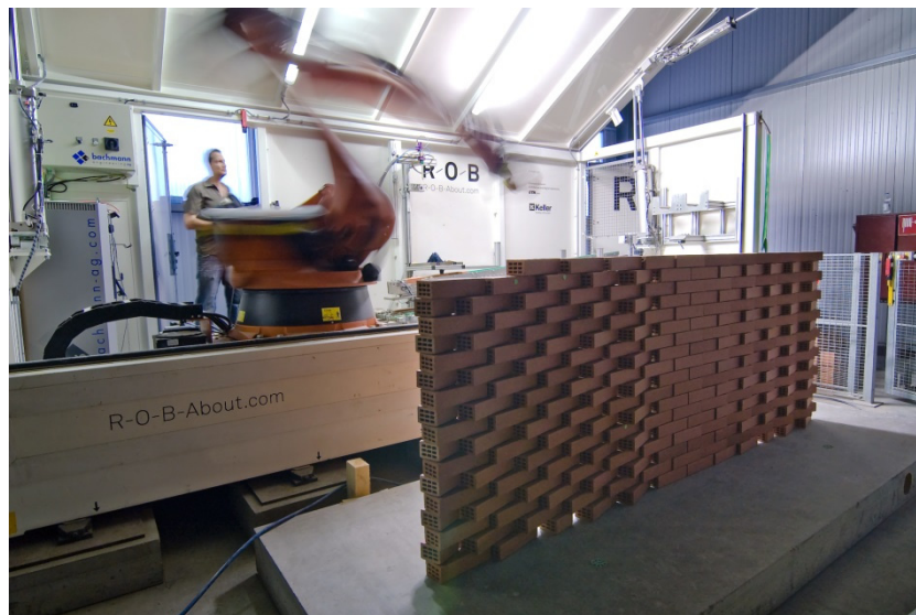
Abbildung 38: Vorfabrikation von Mauerwerkselementen im Projekt Flexbrick unter Verwendung eines Industrieroboters, der aus einem modifizierten Frachtcontainer heraus produziert
