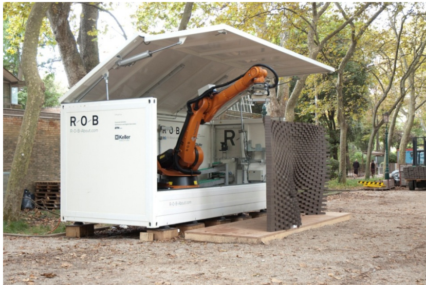
Abbildung 13: Die mobile Fabrikationseinheit R-O-B als Feldfabrik auf der Architekturbiennale in Venedig
