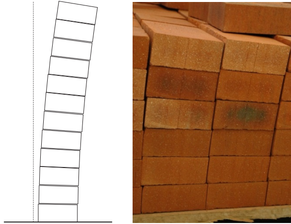
Abbildung 46a und b: Aufgrund der meist auf der kurzen Seite auftretenden konischen Verformung des Backsteins summieren sich die Ungenauigkeiten bei einer Stapelung ohne Mörtel in Vertikalrichtung auf
