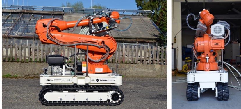
Abbildung 37a und b: Der Experimentaufbau: ein Industrieroboter (ABB IRB 4600 – 255), montiert auf einem kompakten mobilen Unterbau
