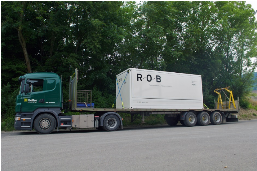
Abbildung 39: Die mobile Produktionseinheit R-O-B lässt sich wie ein Standardfrachtcontainer transportieren
