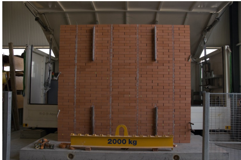
Abbildung 59: Prototyp #3 – Herstellung eines maßhaltigen Leichtbauelementes und Implementierung konstruktiver Bauteile
