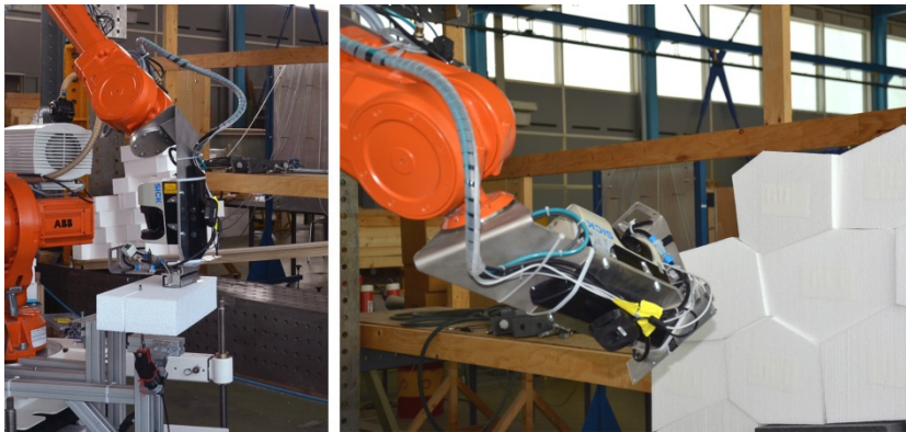
Abbildung 96a und b: a) Der Roboter führt den EPS-Block entlang einer Thermo-Schneidemaschine; b) Nach dem Schneidprozess wird der Block direkt verbaut
