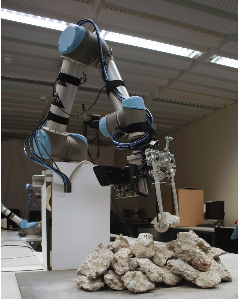
Abbildung 21: In einer Machbarkeitsstudie des Projektes Rubble Aggregations wurden erste Strategien zur Assemblierung von Abbruchmaterialien aufgezeigt
