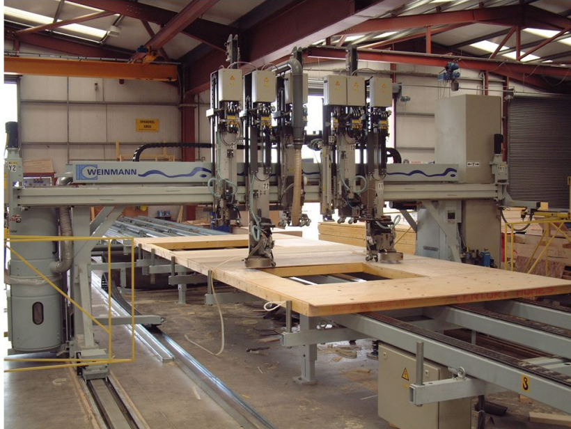
Abbildung 11: Automatisches Beplanken eines Wandelementes mit einer digital ansteuerbaren Multifunktionsbrücke (WMS 150) der Firma Weinmann
