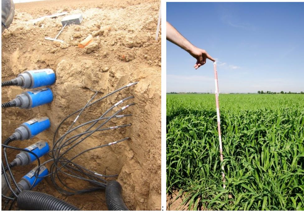
**Abb. 8:** Das linke Bild zeigt exemplarisch ein Bodenprofil mit den fünf TDR Bodenfeuchte Sensoren (links), einer Bodenwärmestromplatte (Mitte) und den Bodentemperatursonden (rechts). Das rechte Bild zeigt die Sommergerste in der phänologischen Phase des Schossens.
