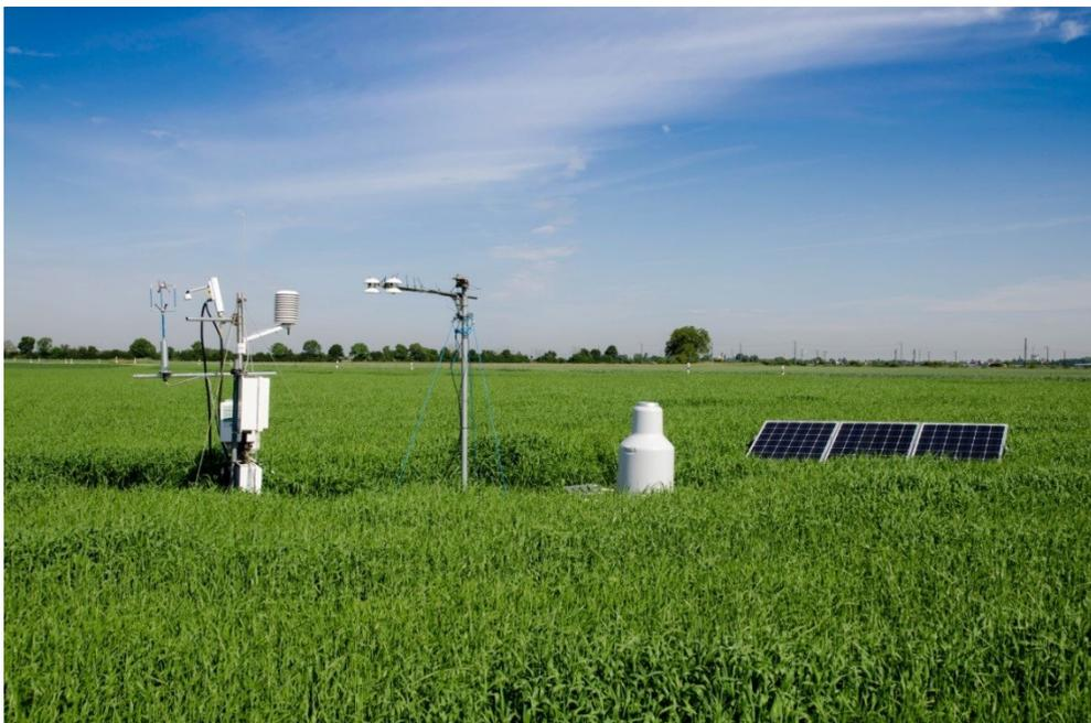
Abb. 7: Klimastation im Jahr 2014. Zu sehen sind neben der Eddy-Kovarianz-Station (links im Bild), das Netradiometer und den Pluvio2 (Mitte) sowie die solarbetriebene Energieversorgung (rechts).
