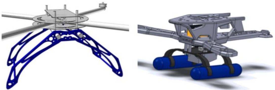
Figura 14: Ejemplo de tren de aterrizaje [15]
