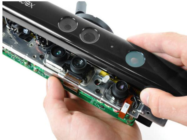
**Figura 3.7** Desmontando la carcasa de Kinect.
