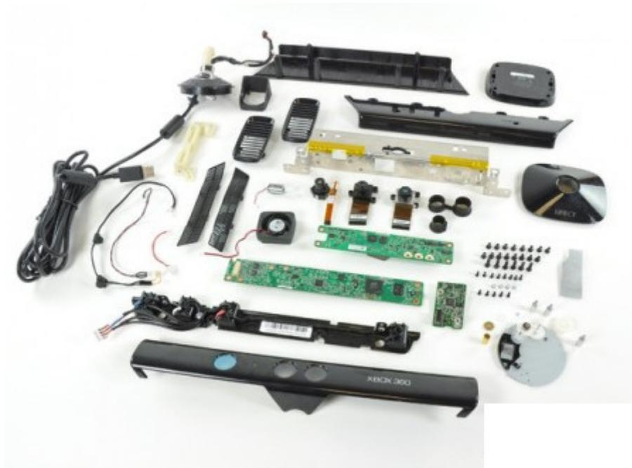
**Figura 3.8** Componentes que forman Kinect.
