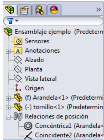
Figura 2.16 Gestor de diseño para ensamblajes.
