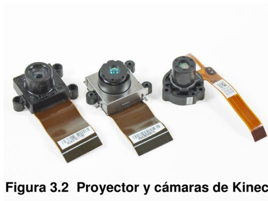
**Figura 3.2** Proyector y cámaras de Kinect.
