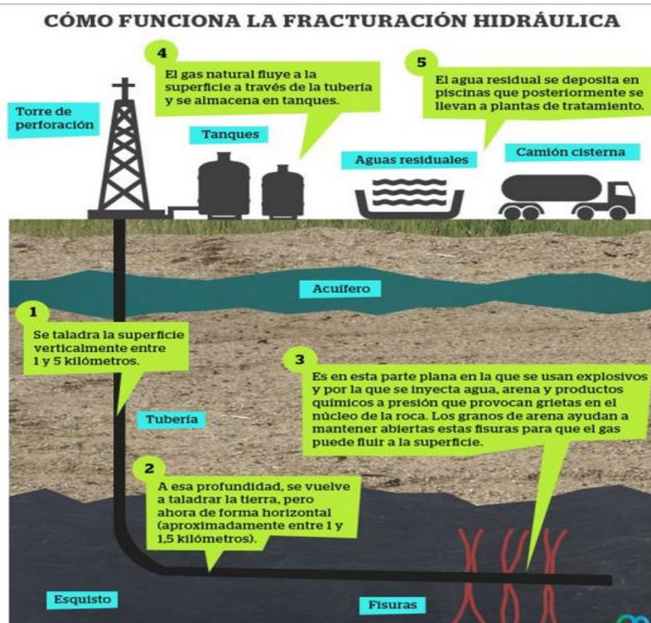
Figura 13: Esquema de funcionamiento de la fracturación hidráulica. Fuente [8]
