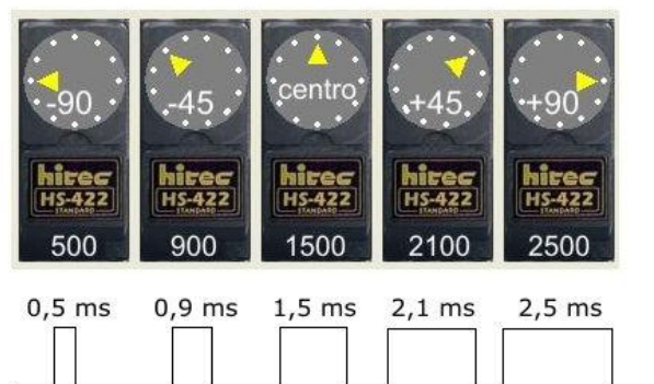
Figura 20. Ancho del pulso según la posición [15]
