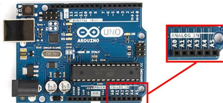
Figura 16. Patillas de entradas analógicas de la placa Arduino Uno. Adaptado de [13]
