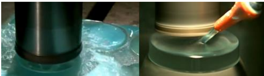
Figura 3.43. Taladro de diamante cortando discos de una placa plana de vidrio y rectificadora dando la forma convexa a una lente Fresnel convencional. Fuente: (Youtube, 2016)
