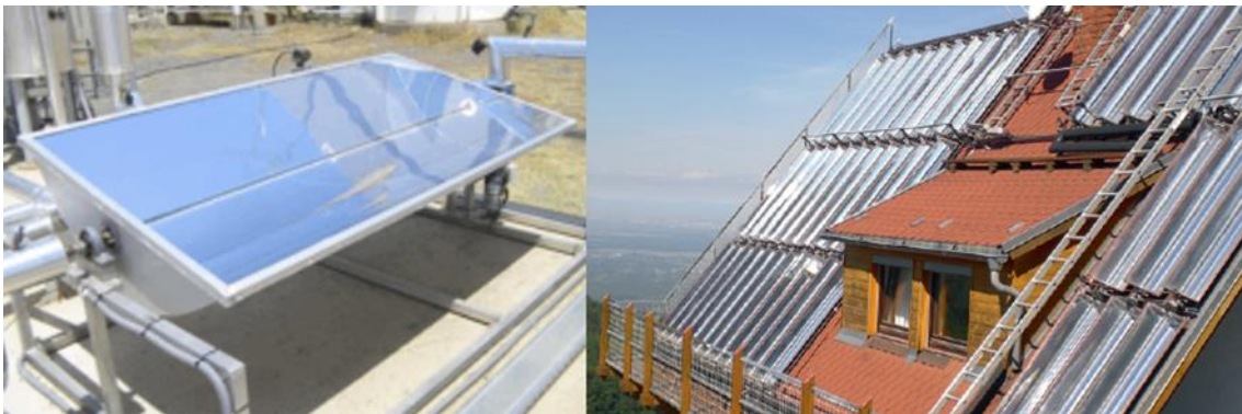
Figura 5.21. Estructura tipo caja de construcciones en concentradores CCP Capsol (izq.) e It.collect (dcha.). Fuente: Plataforma Solar de Almería y Dr. Vetter.
