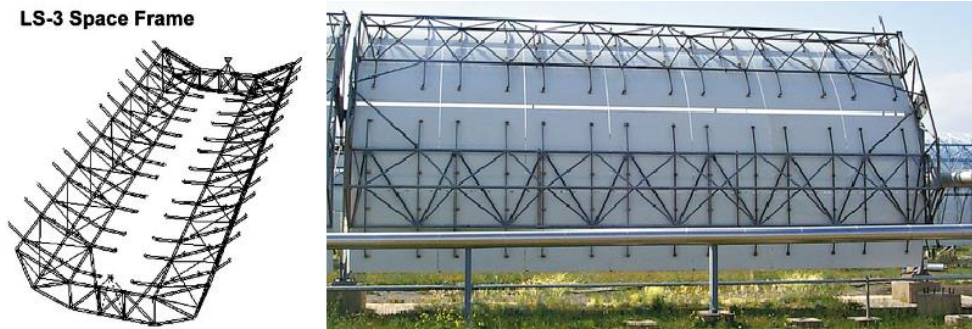
Figura 3.27. Estructura espacial de cerchas en V, colector LS-3 de Solel. Fuente: (Hank Price, 2002), (Google imágenes).
