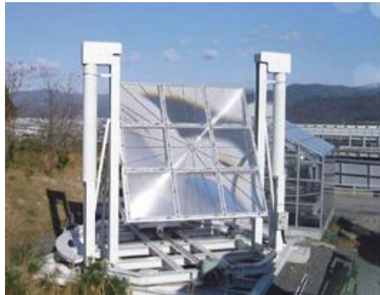
Figura 3.49. Horno solar con tecnología de concentración solar de lentes Fresnel radiales. Fuente: (NTKJ Co., Ltd, 2016).
