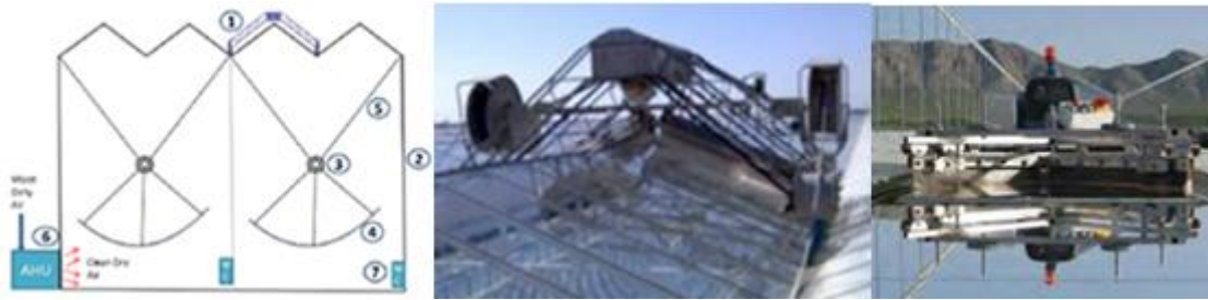
Figura 5.35. Esquema del captador CCP de GlassPoint Solar, y su sistema de limpieza robotizado (centro). Robot de limpieza de facetas en módulo Fresnel. Fuente: GlassPoint y Novatec
