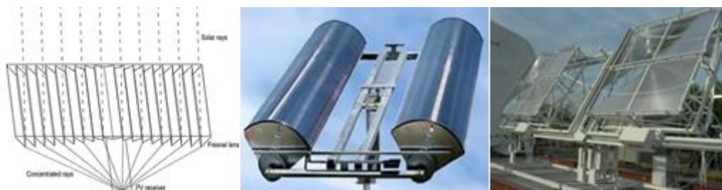
Figura 3.46. Sistema de lentes Fresnel lineal plano, curvado y radial. Fuente: (Entech Solar, 2015), (Google imágenes).
