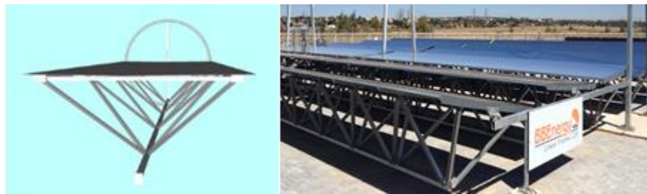
Figura 5.22. Ilustración estructura de soporte espacial de una fila de facetas. Fuente: google imágenes
