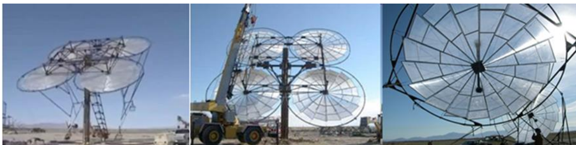
Figura 3.48. Prototipo concentrador solar de lentes Fresnel radial segmentado de gran escala para producción de potencia. Fuente: (IAUS, 2016)
