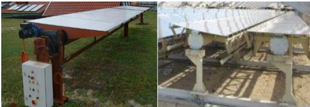
Figura 5.23. Faceta con estructura de soporte tipo tubo de torsión. Fuente: google imágenes e Hitachi Zosen
