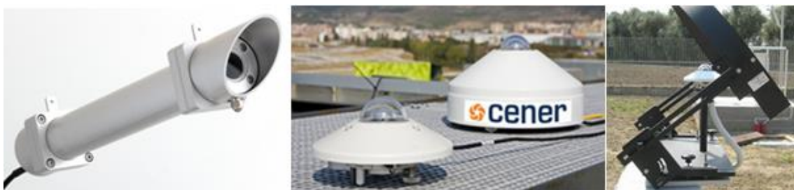
Figura 3.82. Sensores solares: pirheliómetro (izq.) y piranómetro (centro) y piranómetro con banda solar (dcha.). Fuente: (Google imágenes), (CENER, 2016), (SLT Instruments, 2016).
