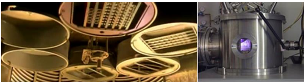
Figura 3.44. Cámara de vacío donde se aplica la capa PVD. Fuente: (Youtube, 2016) y google imágenes.
