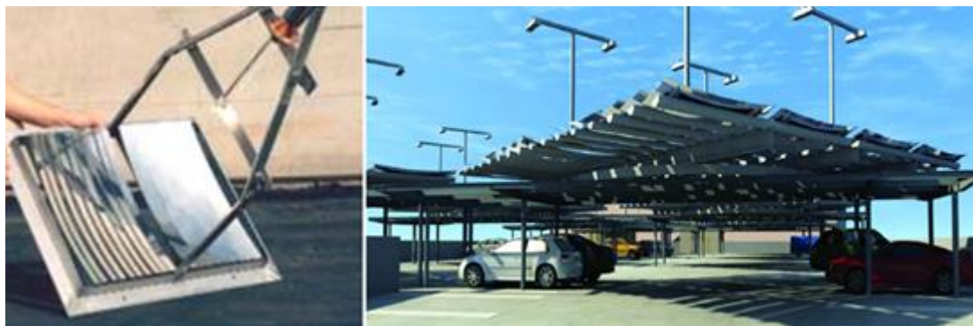
Figura 5.27. Concentradores Fresnel puntuales con estructura tipo A (izq.) y de poste vertical (dcha.). Fuente: google imágenes y Menova Power Spar.
