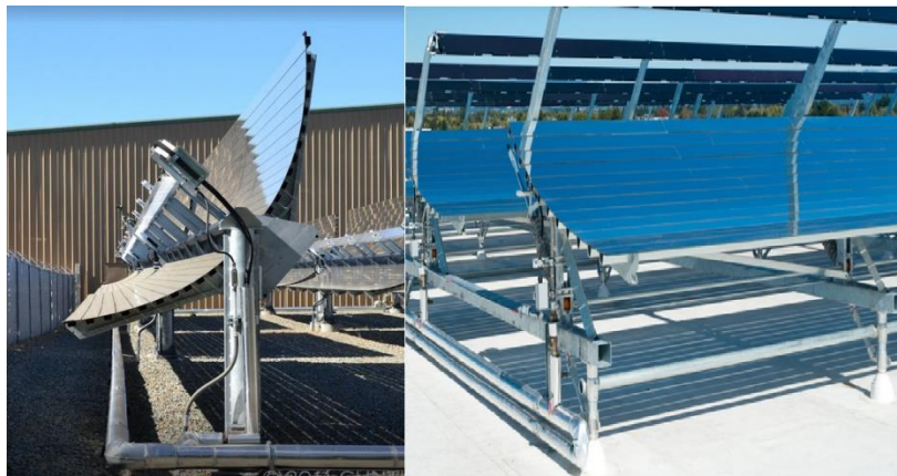
Figura 3.24. Ejemplo de dos versiones del concentrador CCP segmentado de Cogenra. Fuente: (Cogenra, 2015) (greenerdawn).
