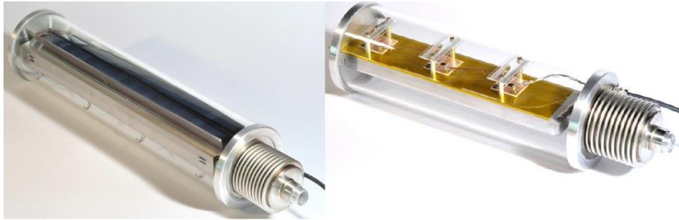
Figura 3.15. Tubos receptores híbridos con células fotovoltaicas de Si monocristalino con sistemas de concentración secundarios acoplados en el interior del tubo (espejos laterales o lentes frontales). Fuente: (SunOyster, 2016).
