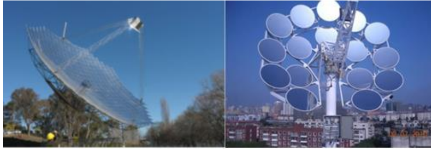
Figura 3.64. Disco parabólico de facetas continuas de 500 m 2 de área de apertura, desarrollado por la Universidad Nacional de Australia (ANU) y matriz discontinua de discos parabólicos de espejos de membrana tensionada. Fuente: (ANU, 2015), (Hi-min Solar, 2016).
