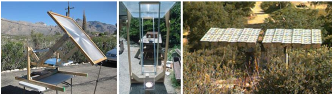
Figura 3.50. Módulos artesanales de lentes Fresnel radiales de pequeña escala para cocina solar y fotovoltaica en EE.UU.. Fuente: (Google imágenes).
