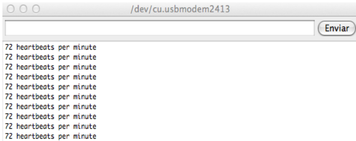
Figura 55. Resultados mostrados por pantalla al calcular el ritmo cardíaco mediante el algoritmo de Pan-Tompkins en la plataforma Intel Edison para el registro 111 de MIT-BIH
