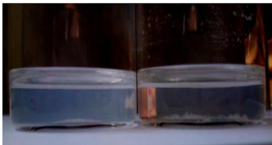
*Figura 4. 6 Estabilidad de alúmina y alúmina-MDI-PSU 16k en dimetilacetamida*
