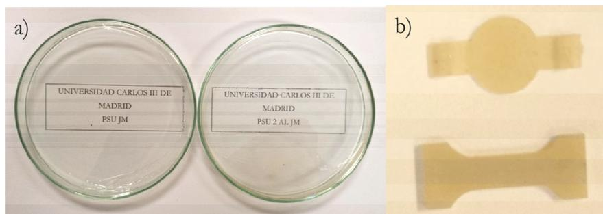
*Figura 6. 2 a) Películas transparentes preparadas a partir de las muestras PSU JM y PSU2-AL-JM, b) probetas de PSU JM tras el proceso de inyección*
