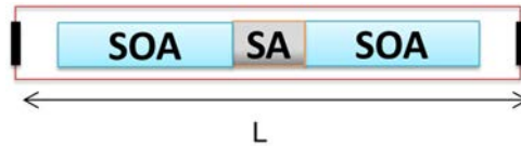
Figura 3.2. Láser mode-locked en configuración lineal, en estructura de CPM. SOA: amplificador óptico, SA: absorbente saturable, L: longitud de la cavidad
