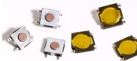
Figura 49 – Distintos tipos de sensores de contacto binarios [10]
