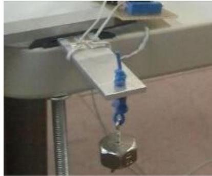
Figura 156 – Prueba del sensor de fuerza fijado en la mesa.
