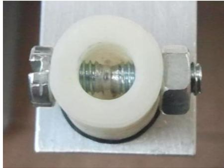
Figura 168 – Pieza de sujeción de los pesos montada en la pletina de aluminio.
