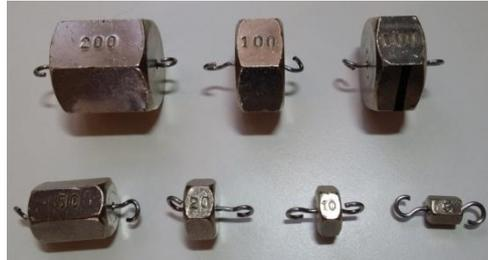
Figura 173 – Pesas de precisión para la toma de medidas.
