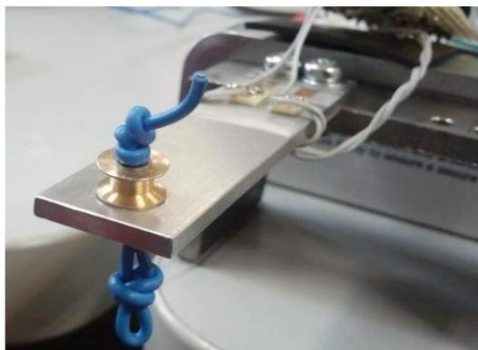
Figura 166 – Pieza improvisada de sujeción del cable.
