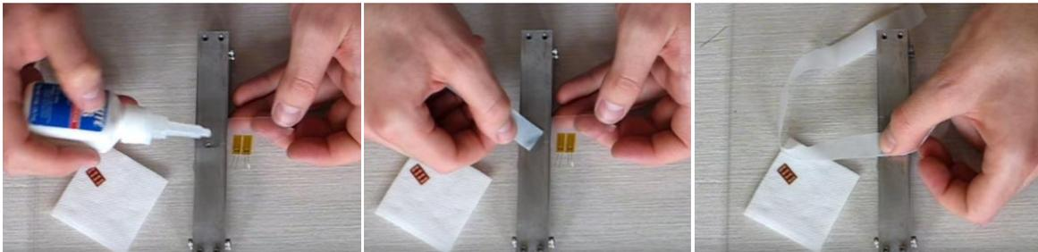
Figura 150 – Pasos para el pegado de las galgas extensiométricas. [25]
