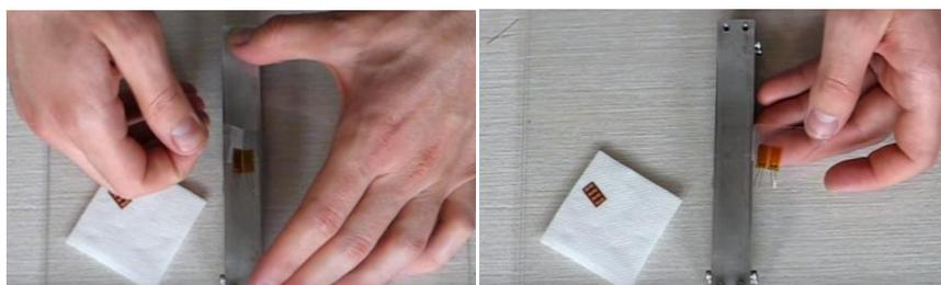
Figura 149 – Despegado del celo con las galgas adheridas a éste. [25]
