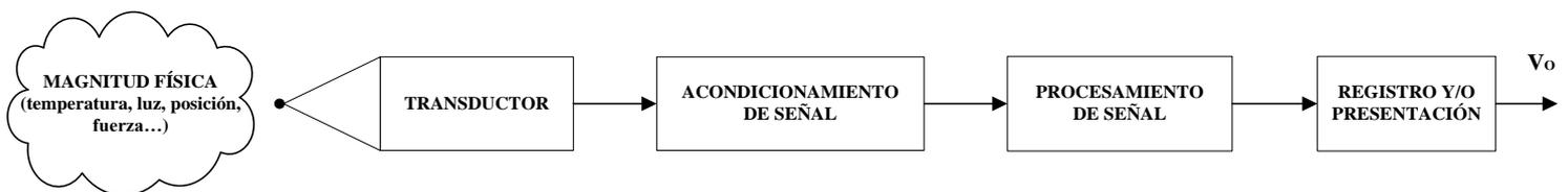
Figura 60 - Diagrama de bloques de un sistema de instrumentación
