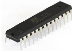
**Figura 4.15: Microcontrolador Atmel ATmega328P**
