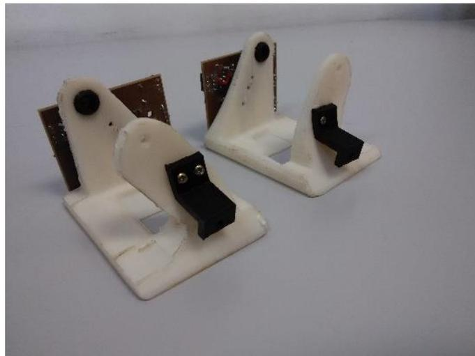
**Figura 6.43: Pie robótico con PCB y soporte para los sensores instalados**
