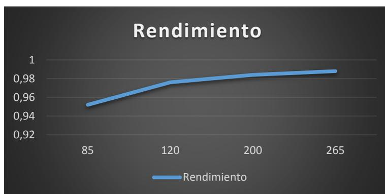
Figura 2. 156: Gráfica de rendimiento en función de la tensión de entrada
