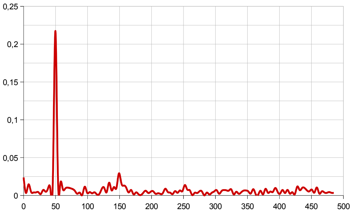
Figura 22. Transformada de Fourier de la Corriente del Flexo
