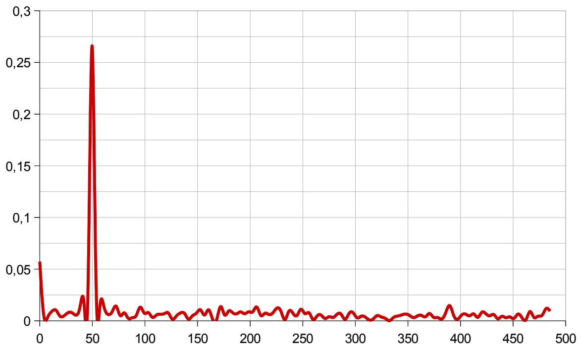
Figura 70. Transformada de Fourier de la Corriente del Ventilador
