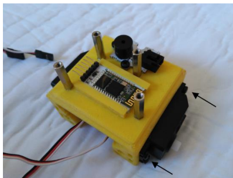
Figura 49. Montaje de los servos en el Cuerpo
