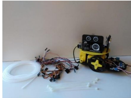
Figura 64. Cableado de los elementos de Domobot
