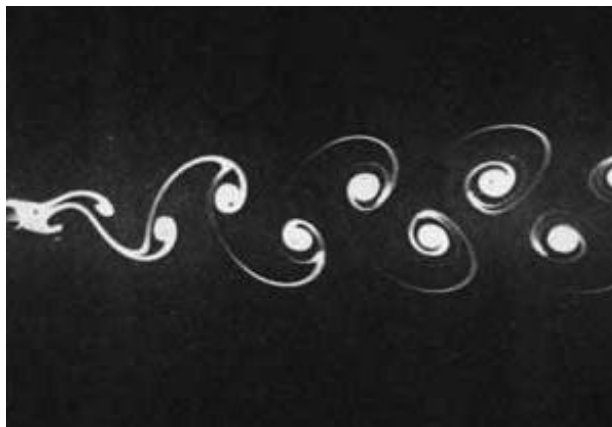
Figura 1.3.1.2. (17) Calle de torbellinos en una estela turbulenta. En concreto se trata de la calle de vórtices de von-Kármán, concepto al cual se hará alusión en capítulos posteriores.
